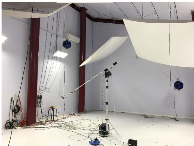
Figura 3.9: Setup di misura Appendice D UNI EN ISO 3741.
