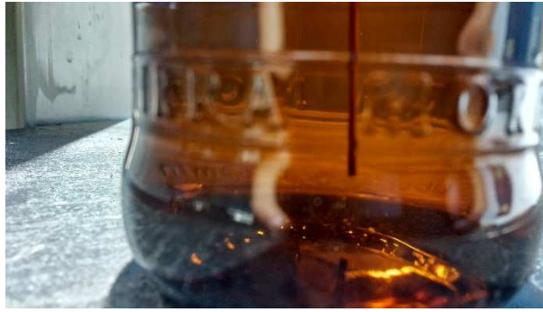
Figura 3.14 Dettaglio della sonda di temperatura che rileva la temperatura a Cold Spot
