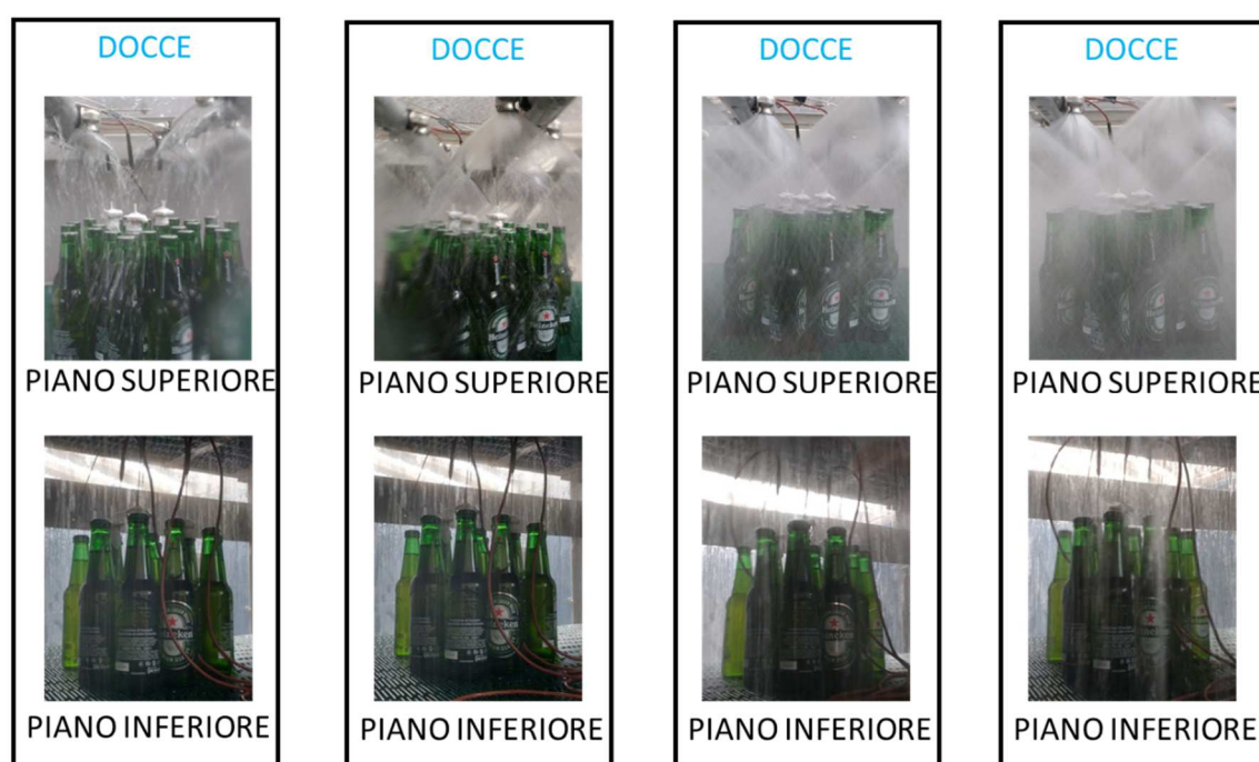
Figura 4.4 Bottiglie in vetro da 330 ml di birra analizzate con test a diverse portate di acqua per le docce di trattamento termico
