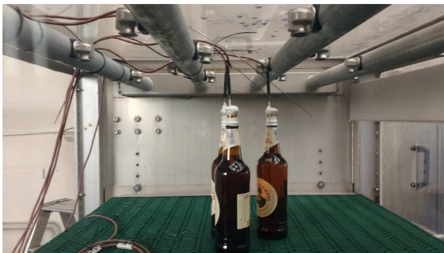
Figura 3.15 Termocoppie usate per misurare l'effettiva temperatura della doccia nella camera
