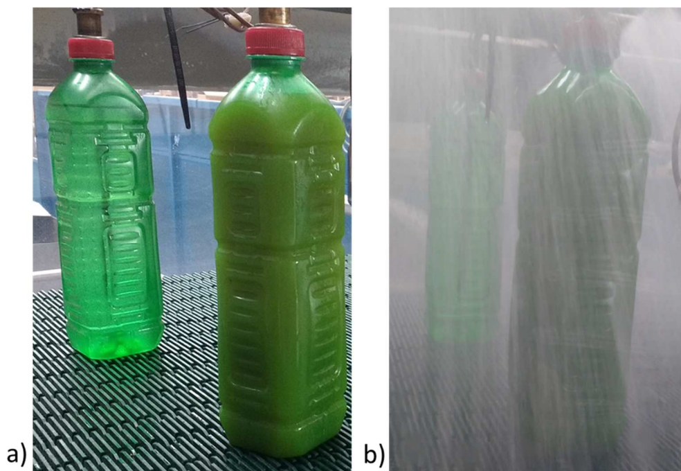
Figura 5.11 Campioni di fluidi alimentari e corrispettivo di acqua nel formato PET 1500 ml a) appena inseriti nella camera di prova e b) durante una fase del test di abbattimento multiplo
