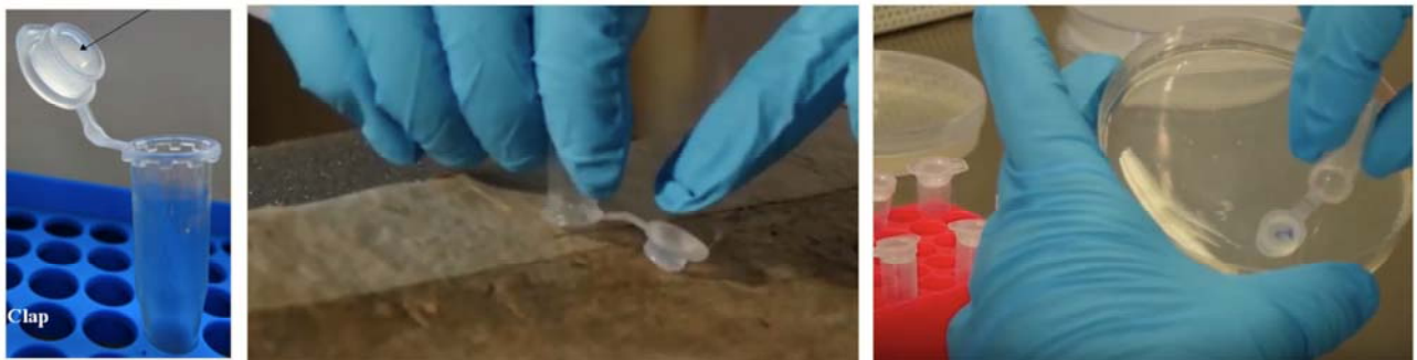
Fig. 1. Tampone clap (a sinistra); fase di prelievo sul libro (al centro); trasferimento del campione su piastra Petri sterile (a destra).
