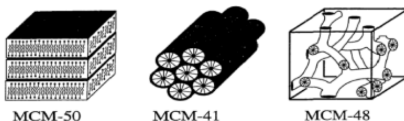
Figura 7: MCM-50 (lamellare); MCM-41 (Esagonale); MCM-48 (Cubica)
