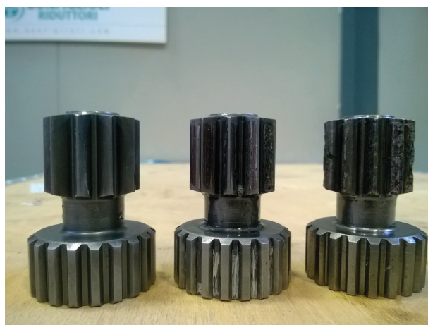
Figura 5.29: Test 4 - Confronto tra i solari del secondo stadio utilizzati: a sinistra un ingranaggio nuovo, al centro il solare estratto dal Riduttore A alla fine del Test 3, a destra il solare estratto dal Riduttore A alla fine del Test 2.
