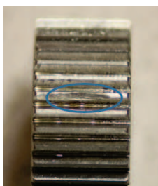
Figura 3.20: Difetto localizzato sul satellite del primo stadio.
