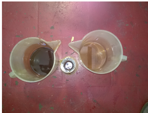
Figura 5.9: Olio contenuto dei riduttori a fine della prova: a sinistra l'olio contenuto nel riduttore e a destra l'olio contenuto nel moltiplicatore.
