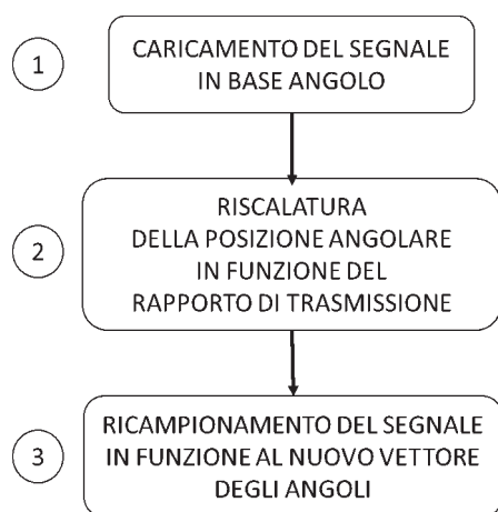
Figura 4.4: Schema a blocchi dell'algoritmo per il ricampionamento ad incrementi angolari costanti di un segnale temporale attraverso un rapporto di riduzione.
