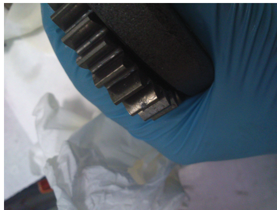
Figura 5.4: Satellite del primo stadio con un difetto localizzato artificiale sul profilo di uno dei denti.
