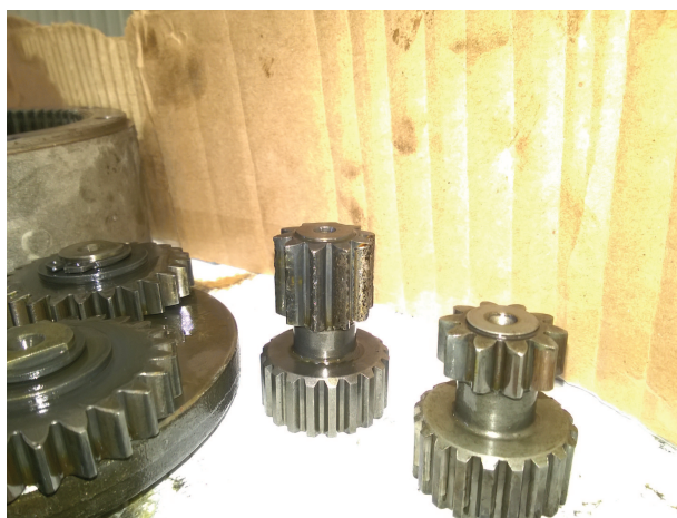
Figura 5.10: Condizione del solare del primo e del secondo stadio per il Riduttore A alla fine del Test 2.
