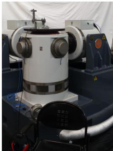
**Figura 3.4:** shaker tri-assiale disponibile presso il laboratorio di ingegneria a Ferrara.
