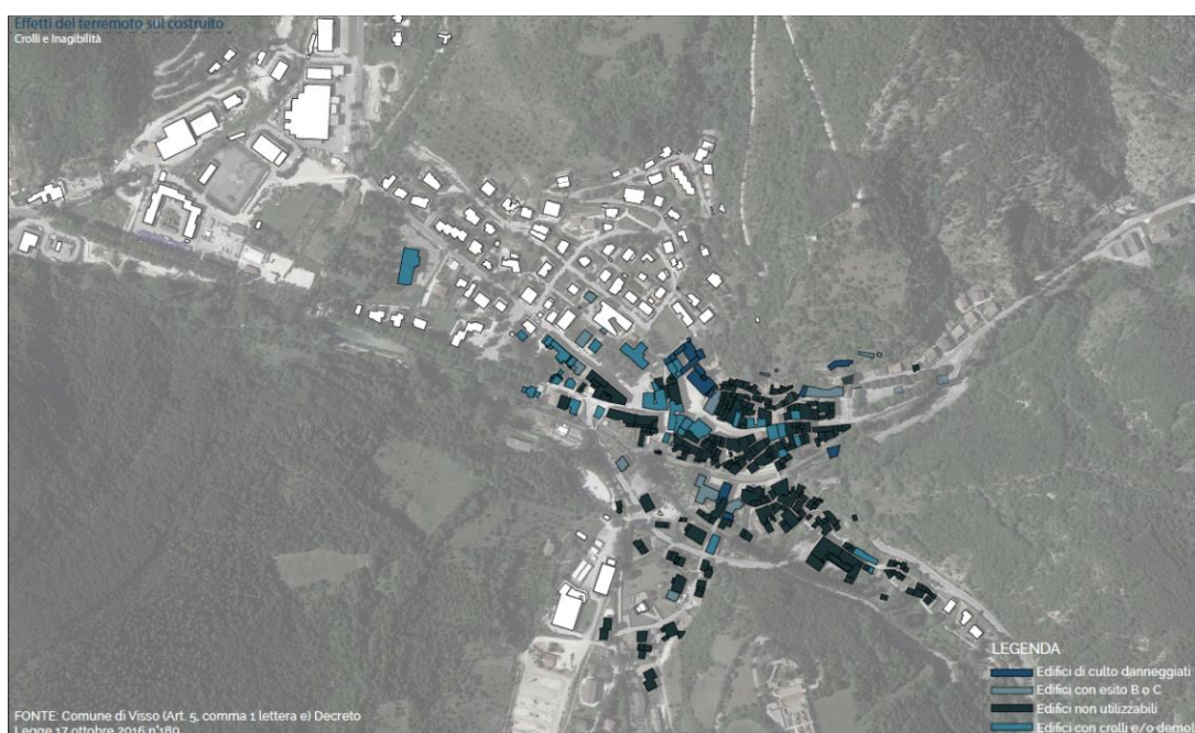
Figura 1 | Visso: effetti del terremoto sul costruito
