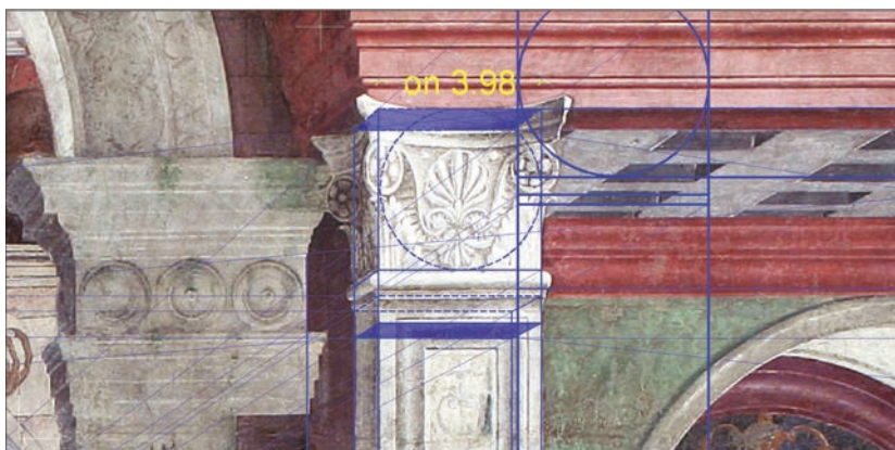
Fig. 10. Il pilastro in primo piano che in vera forma misura 1 + \frac{1}{2} palmo, in prospettiva diventa di 1 + \frac{1}{3} palmo; il rapporto che lega i due numeri ( 1,55:1,33 ) è di 1.1666, cioè di \frac{7}{6} .
