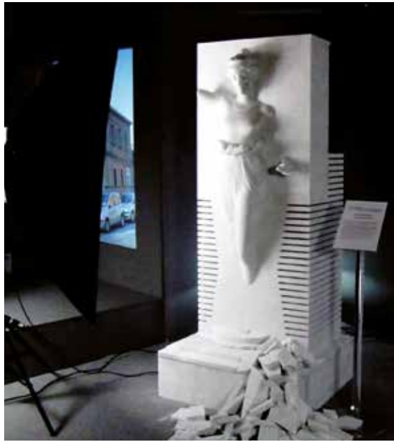
Modello interpretativo dell'Ebe del Canova di Forlì, realizzato in marmo tramite tecniche CNC. Nel modello si sono simulate anche diverse tipologie di pattern superficiali in relazione al possibile uso sull'integrazione di parti scultoree e su manufatti originali. In alto la fase di acquisizione e il modello finito esposto, sotto le fasi di lavorazione CNC e il dettaglio dei pattern di finitura. Progetto di ricerca del Centro DIAPReM dell'Università di Ferrara e del Laboratorio CAI Lab di Archeoingegneria dell'Università degli Studi di Bologna in collaborazione con la Pinacoteca Civica di Forlì, realizzazione Marmo Casa srl di Modena (di lato) Interpretative model of Ebe by Canova of Forlì, built with CNC techniques in marble. In the model they have simulated different types of surface pattern in relation to the possible use of sculptor parts on the integration of original artifacts. Above, the acquisition phase and the finished model exhibited. The images below represent the CNC machining phases and the detail of finishing pattern. Project by DIAPReM Research Centre of Ferrara University and CAI Lab Archeoingegneria Laboratory of the University of Bologna in collaboration with the Civic Art Gallery of Forlì, made by Marmo Casa srl - Modena (on the left)
