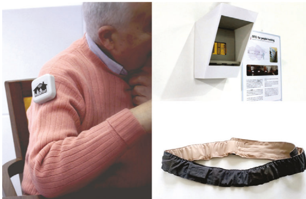
Fig.03 Nella figura si possono notare: il tag , posizionato come spilla nella manica del maglione; l'antenna radio reader , assimilata all'interno di un applique luminosa; il sistema inerziale, integrato all'interno di una cintura.
