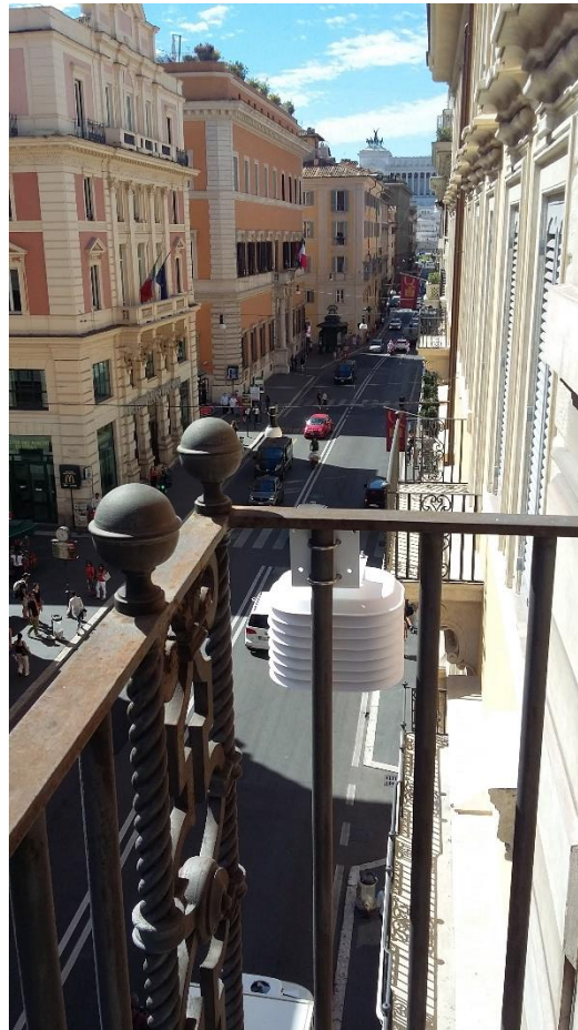
Figura 2. Sensore di temperatura su via del Corso. Fonte: ARPA Lazio.
