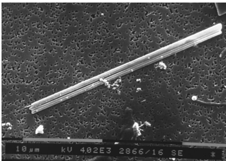
Figura 2. Immagine al SEM di una fibra di anfibolo di amianto rimasta inalterata. I segmenti di riferimento corrispondono a 10 \mu\text{m} .
