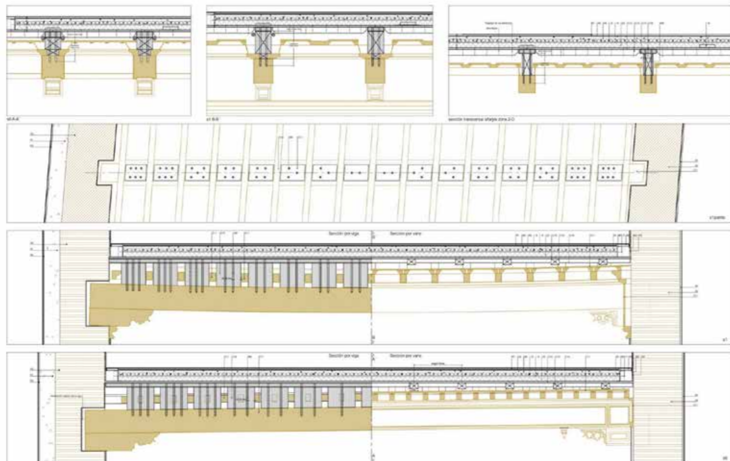
Dettaglio costruttivo: in evidenza il nucleo di bretelle metalliche nascoste all'interno delle travi di legno
