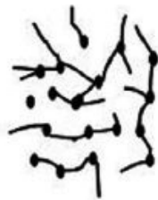
Fig.22: Reazione di propagazione di microgeli formatisi per reazione di reticolazione di miscele UPR/stirene.
