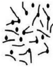
Fig.21: Fase di inizio della reazione di reticolazione di miscele UPR/stirene.
