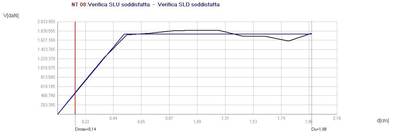
Figura 260: Curva di capacità - Push-over n°3
