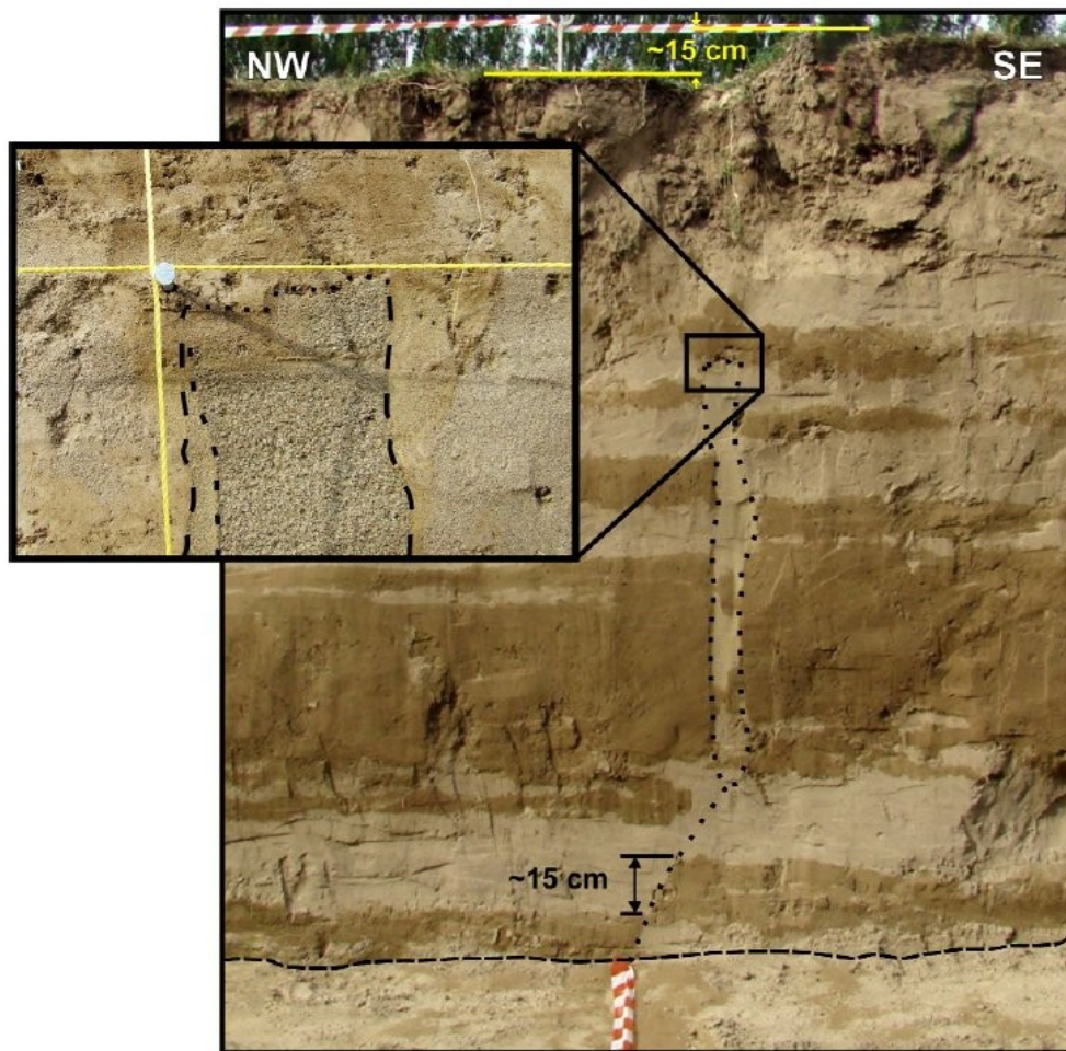
Figura 2.37 - Esempio di risalita di sabbia entro una frattura osservata con la trincea paleosismologica di San Carlo che testimonia l'occorrenza di un effetto di liquefazione anteriore a quelli del maggio 2012 (Caputo et al., 2012).
