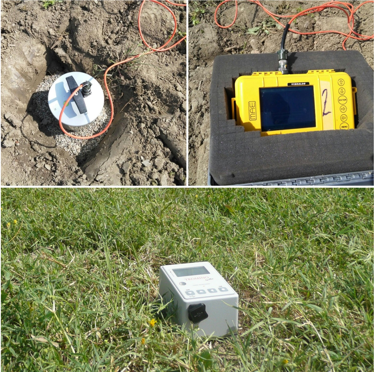
Figura 4.4 - Strumentazione per l'acquisizione di microtremori a stazione singola. In alto: sismometro (a sinistra) e sismografo (a destra) MAE ® . In basso: tromografo digitale Tromino ® prodotto da Micromed ® .
