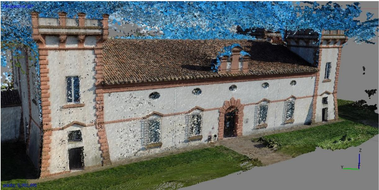
*Figura 9.6. Nube di punti densa realizzata utilizzando le immagini acquisite delle singole facciate.*
