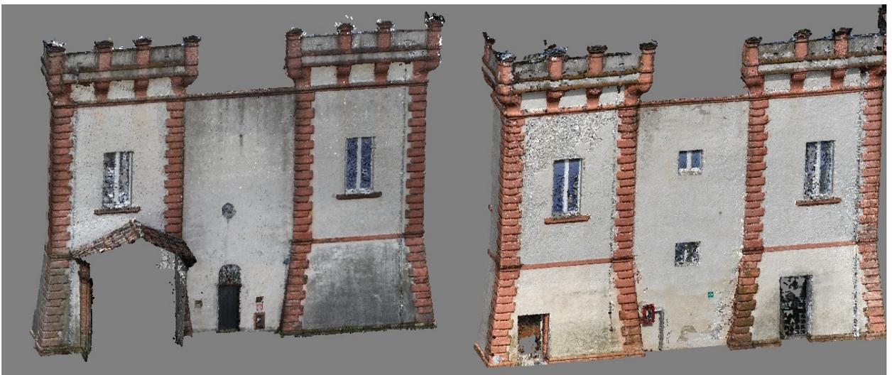
*Figura 8.13. Nubi dense di punti dei prospetti nord e sud ottenuto dal rilievo fotogrammetrico terrestre.*
