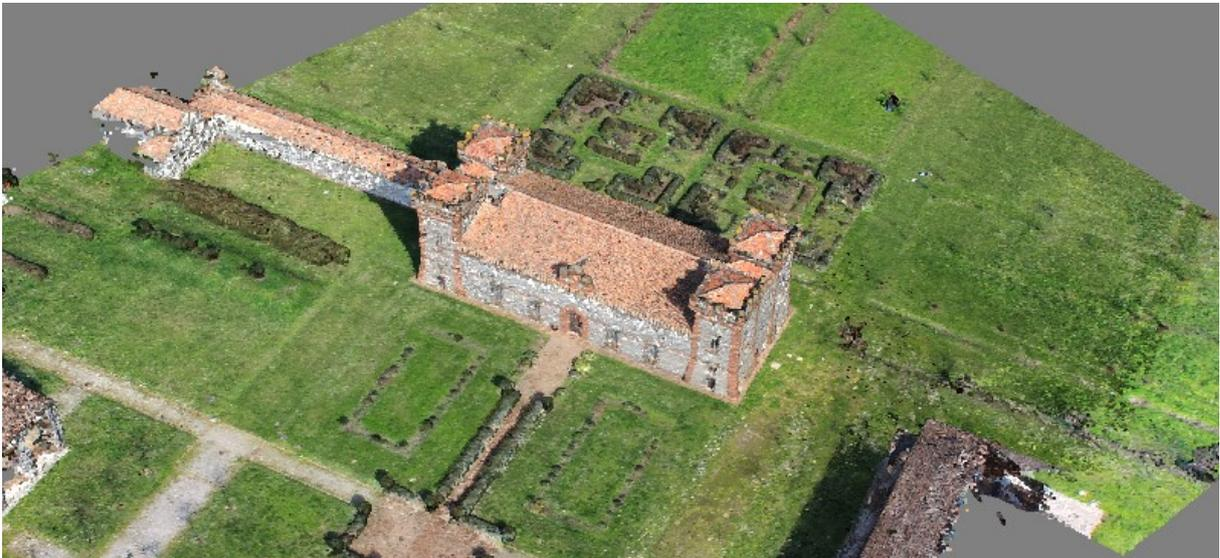
*Figura 8.10. Nube densa di punti ottenuta con le immagini aeree ad assi inclinati.*
