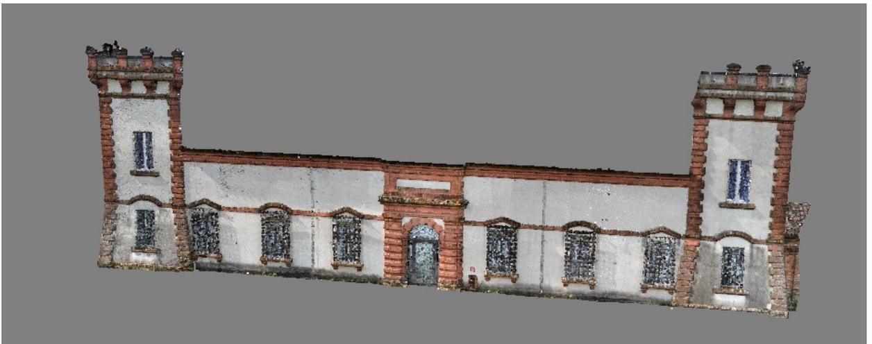
*Figura 8.12. Nube densa di punti del prospetto est ottenuto dal rilievo fotogrammetrico terrestre.*
