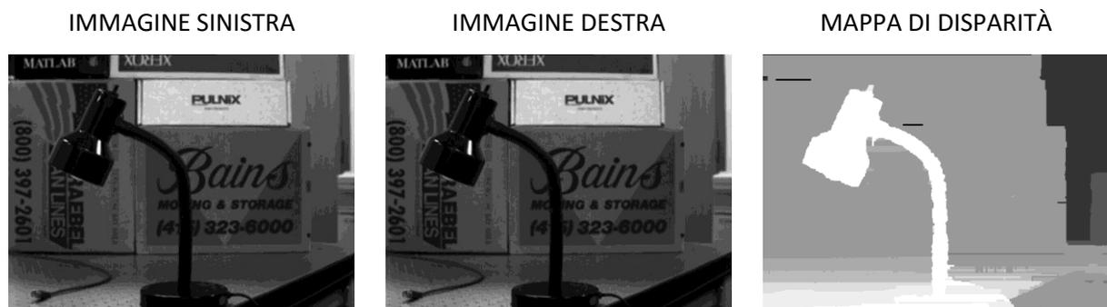
Figura 5.5. Coppia di immagini stereo e mappa di disparità (immagini da: [http://www.ces.clemson.edu/~stb/research/stereo\\_p2p/](http://www.ces.clemson.edu/~stb/research/stereo_p2p/))
