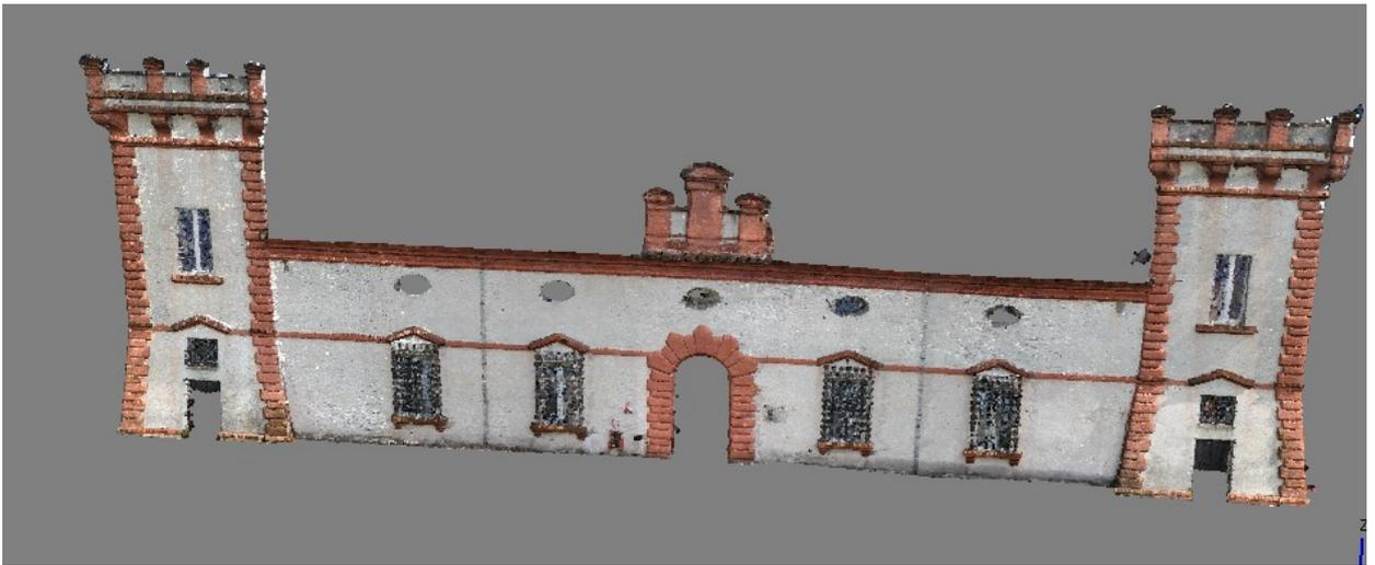
*Figura 8.11. Nube densa di punti del prospetto ovest ottenuto dal rilievo fotogrammetrico terrestre.*
