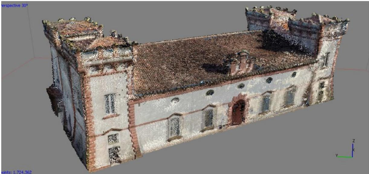
**Figura 9.19.** Nube densa di punti ripulita per il confronto con la nube di riferimento
