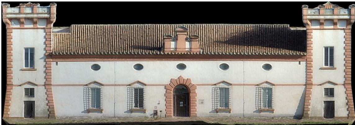
*Figura 10.8. Ortofoto della Facciata frontale (prospetto Ovest). È possibile vettorializzare l'immagine in ambiente CAD per restituire la tavola del prospetto del fabbricato in esame.*
