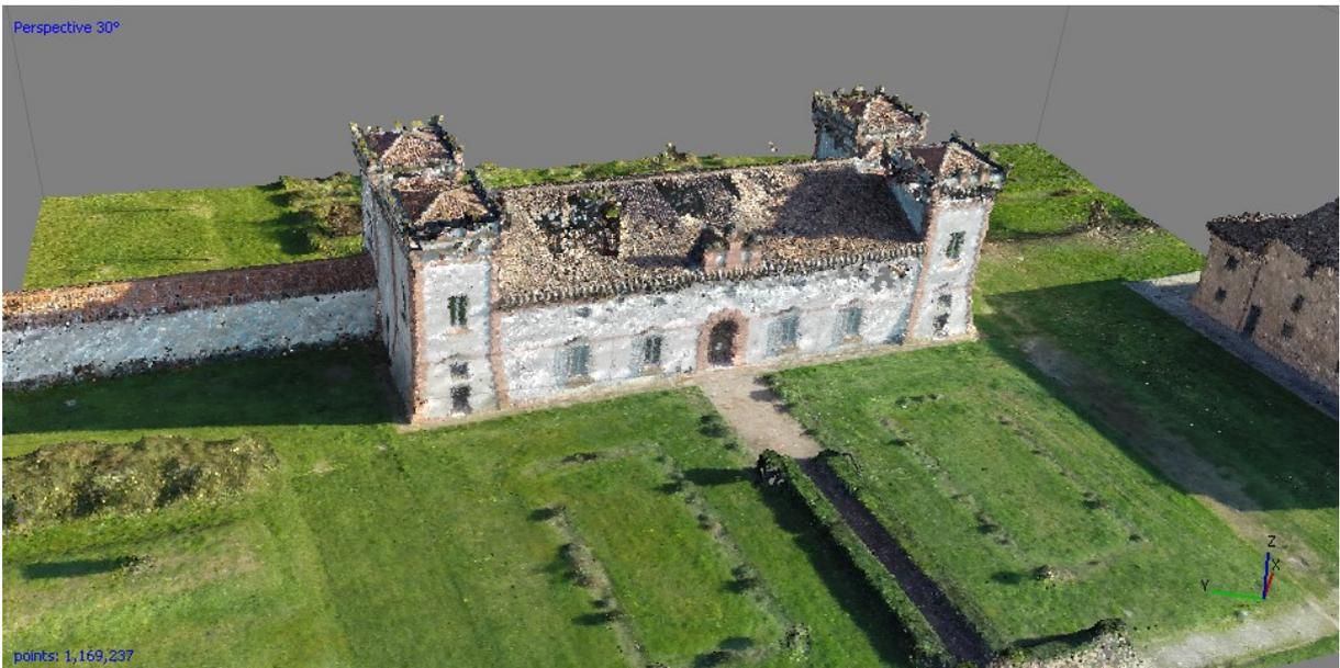
*Figura 9.7. Nube di punti densa del modello integrato.*
