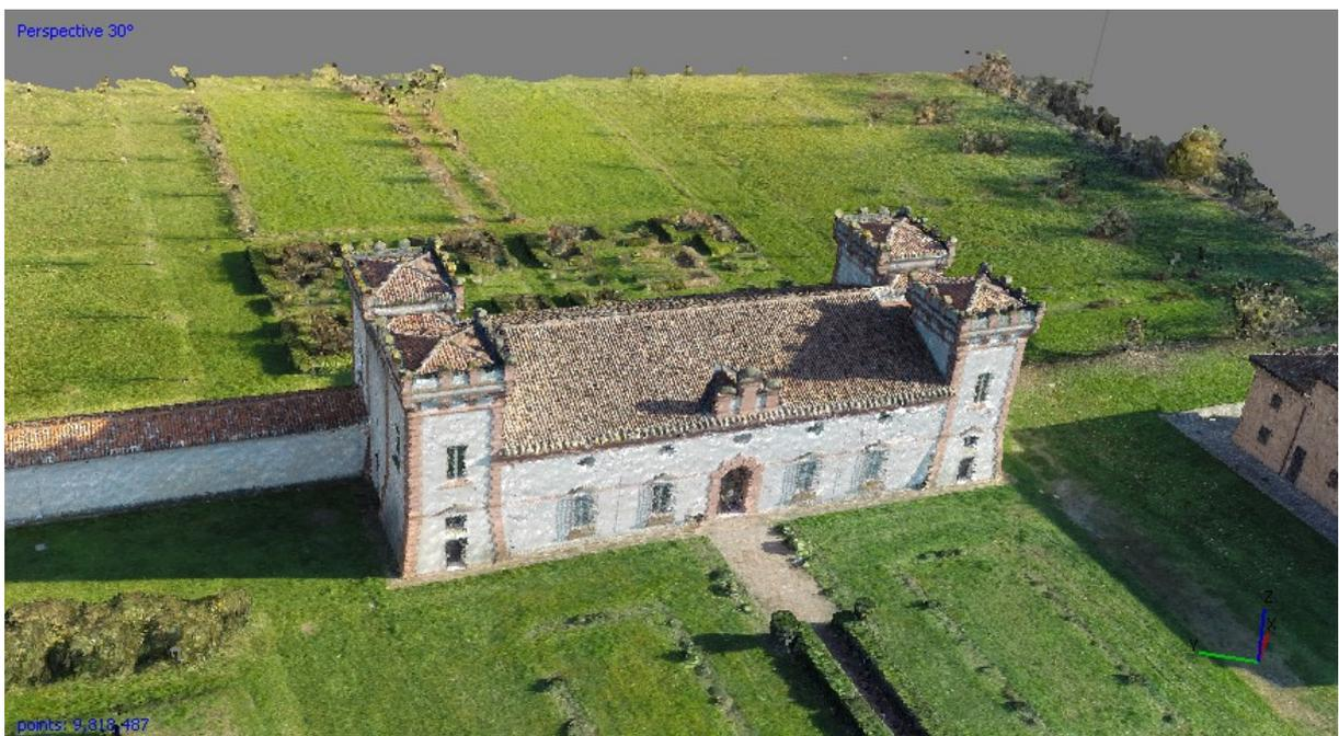
*Figura 9.10. Immagine della nube densa di punti del modello integrato ottenuta a partire da 670 immagini.*
