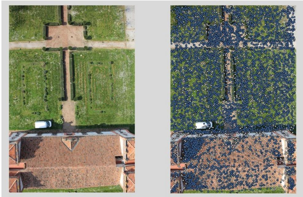
*Figura 10.1. Immagine originale (sinistra). Punti caratteristici individuati sull'immagine (destra)*
