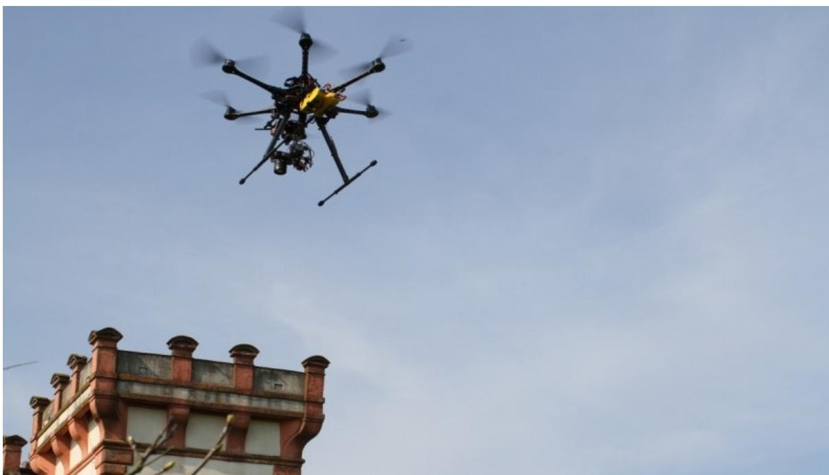
*Figura 8.1. Drone impiegato per l’acquisizione del dato tramite rilievo aerofotogrammetrico.*
