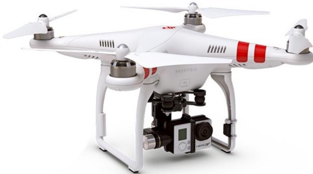
*Figura 9.1. Remotely Piloted Aircraft Systems (RPAS) utilizzato nella sperimentazione. Dji Phantom 2 equipaggiato con una fotocamera ultraleggera GoPro Hero 3+ Black Edition.*
