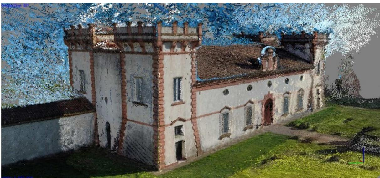
*Figura 9.18. Vista della nube densa di punti ottenuta con frames estratti da video.*
