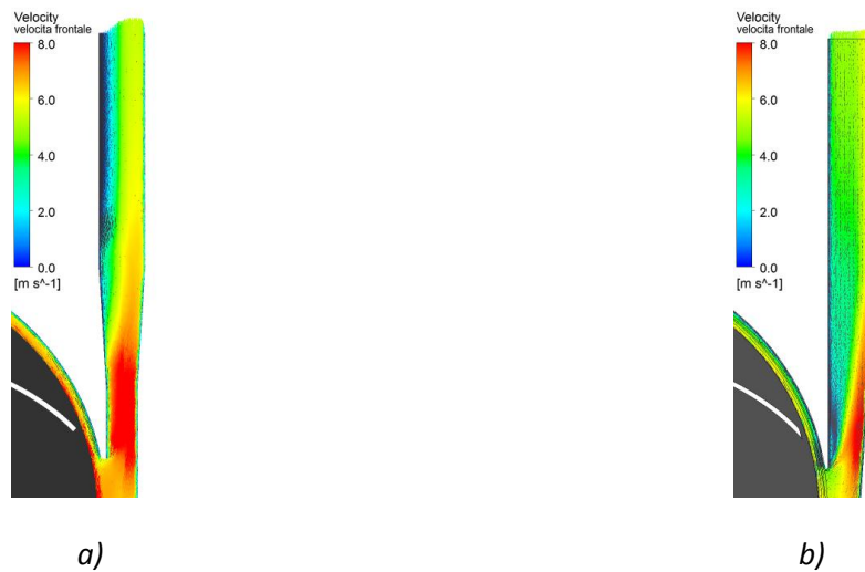
Figura 5.19 – Vector Plot della velocità a Q = 80 l/min, a) geometria standard e b) geometria Evo2.
