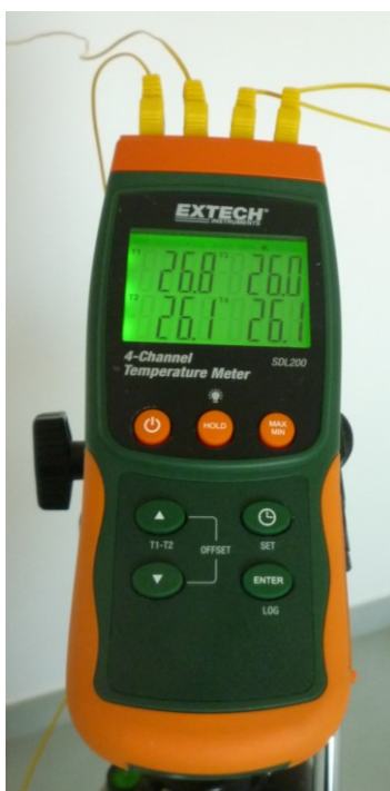
Figura 22 Data logger con termocoppie utilizzato per la misura della temperatura superficiale di parete
