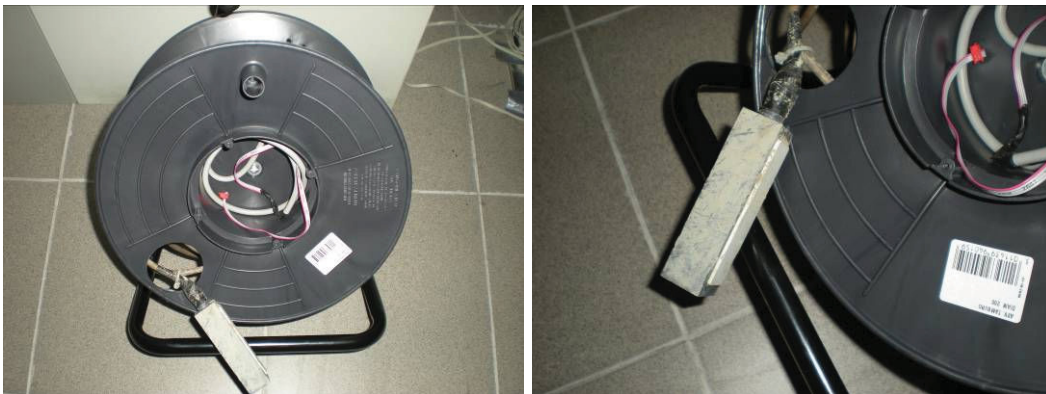
Figura 4: Immagini dell'avvolgicavo e del contenitore ermetico che racchiude l'inclinometro utilizzato per i test di confronto con la sonda inclinometrica di riferimento.
