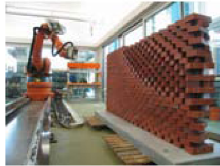
4.10-4.11 Gramazio & Kohler, The Programmed Wall, ETH di Zurigo, 2006
