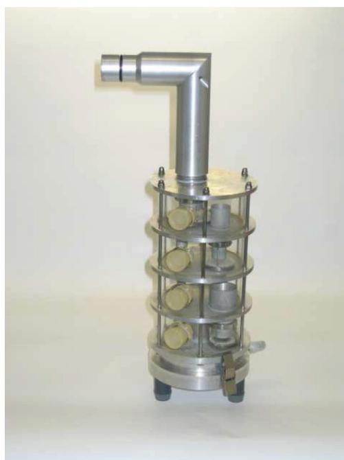
Fig.3.10: Immagine del "Multi-stage liquid impinger"
