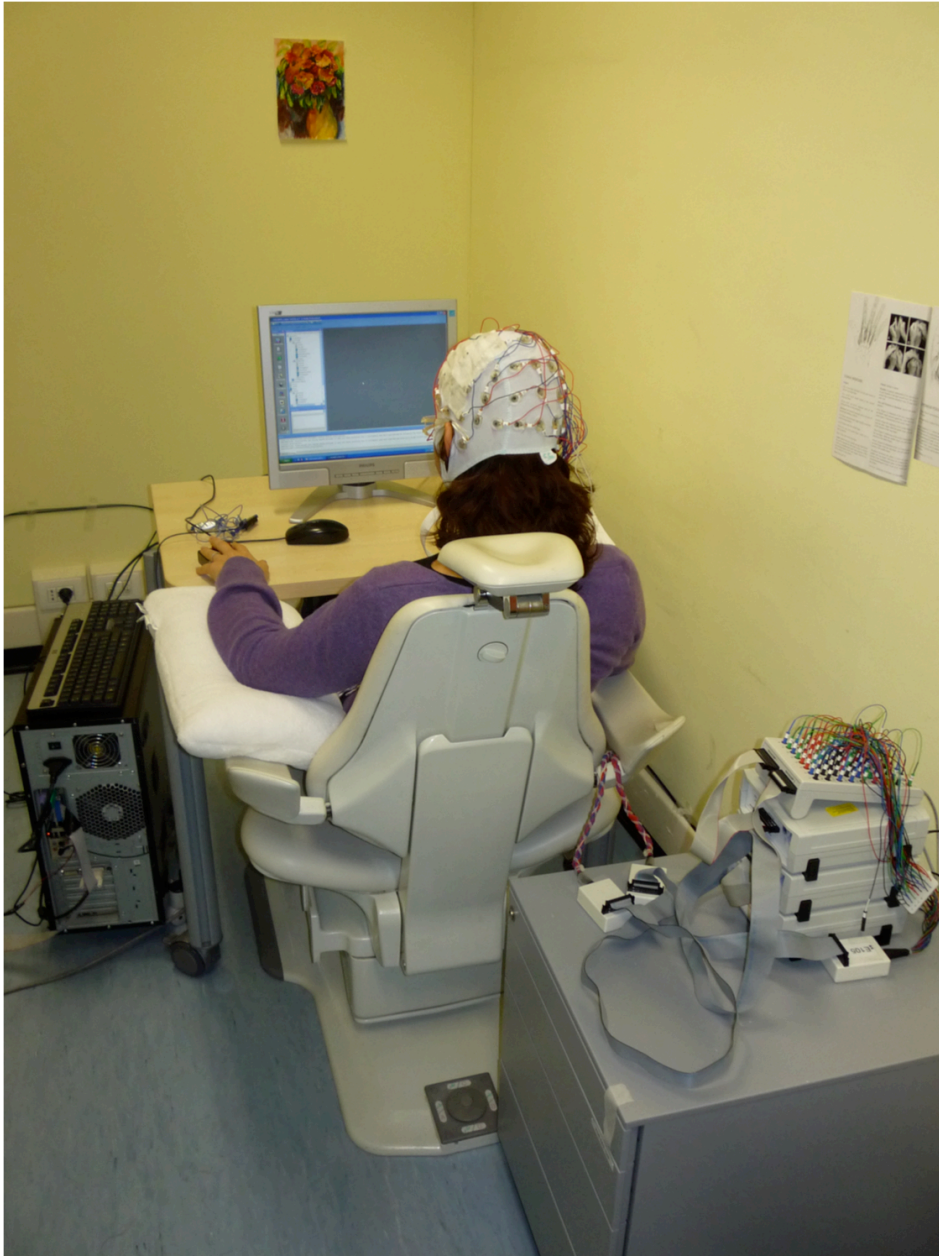
Fig.3: setup sperimentale. Posizione del soggetto durante la registrazione del tracciato EEG.
