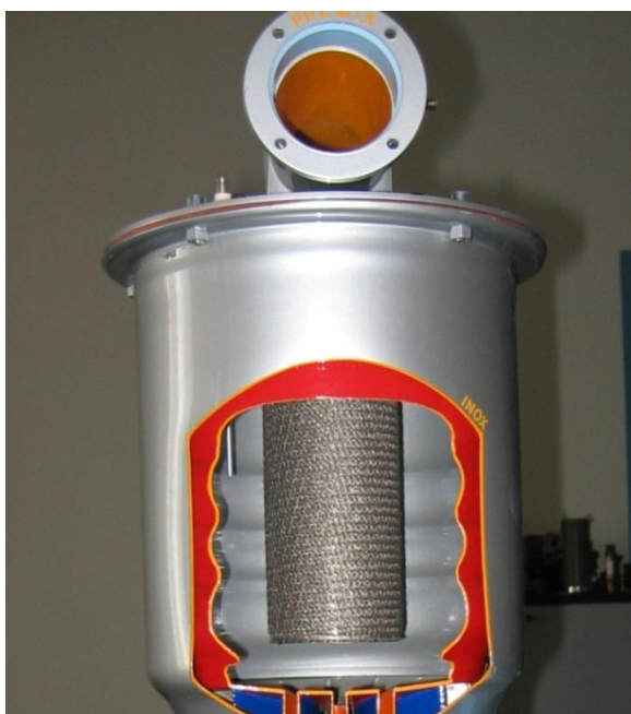
Figura 8. 1– Sezione della camera di combustione
