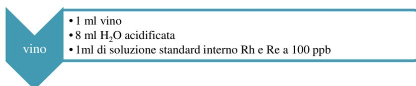
*Fig.18 Schema descrittivo del procedimento di diluizione del vino*
