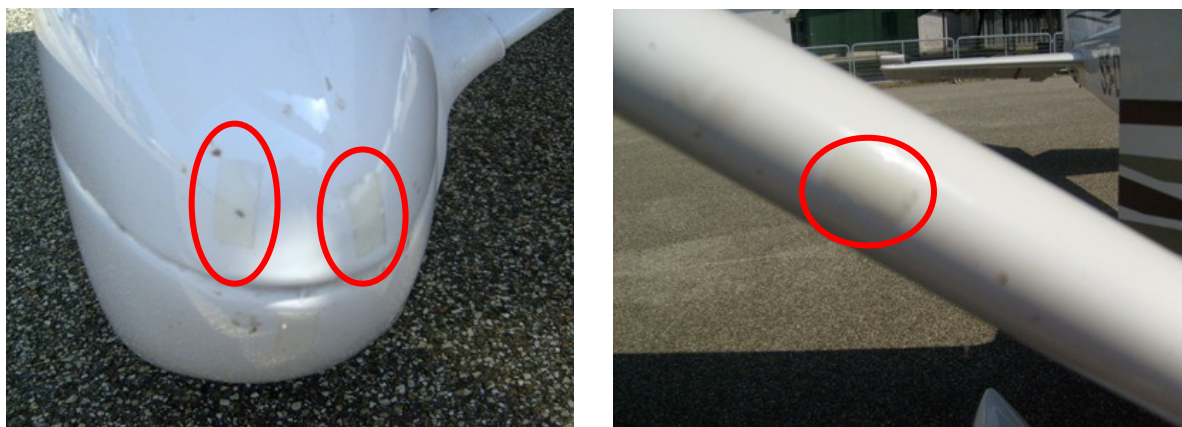
Fig. 173. Foto del nastro biadesivo applicato al carrello ed all'ala del velivolo.
