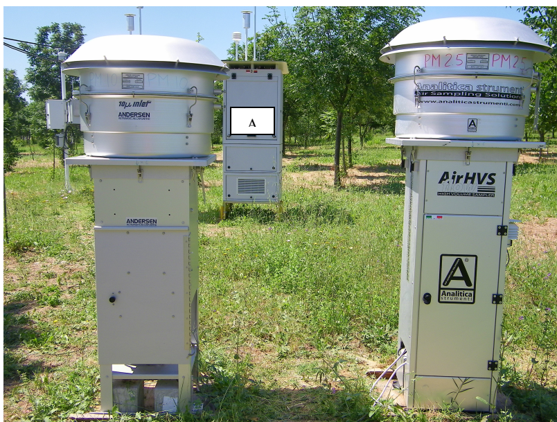
Fig. 136. Foto degli impattori Andersen ed in mezzo dietro il FAI HYDRA (identificato da lettera A).
