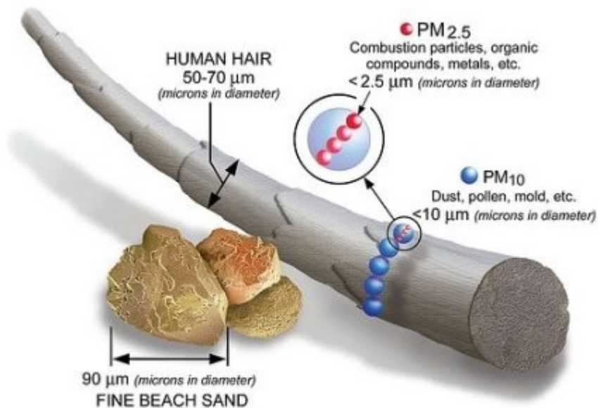
Fig. 10. Esempio sulle dimensioni del \text{PM}_{10} e del \text{PM}_{2,5} [Coffaro, et al., 2006].
