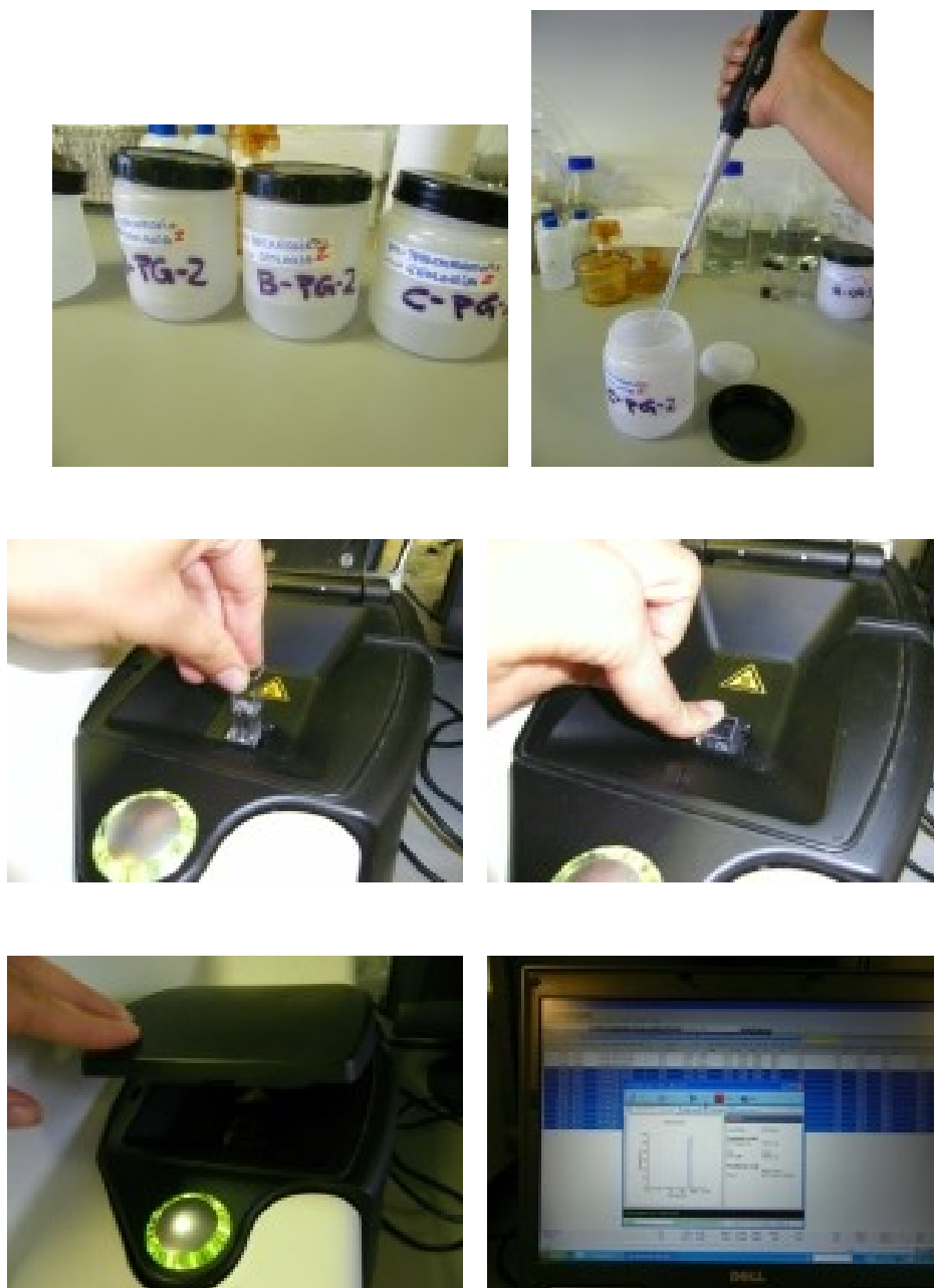
Fig. 38. Sequenza di preparazione del campione per l'analisi in DLS.
