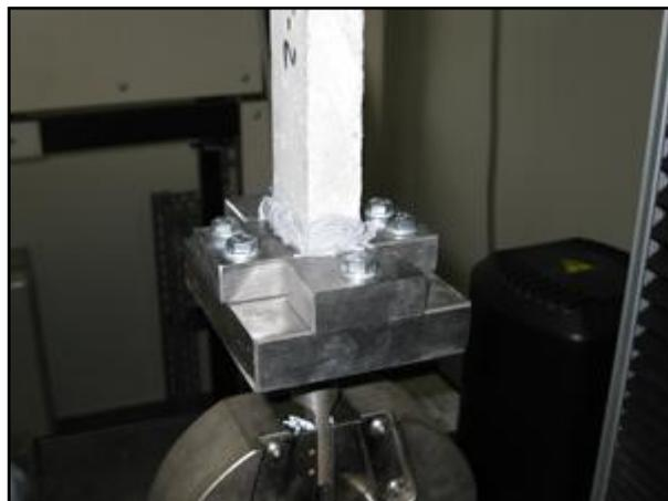
*Figura 3.28 – Prove di trazione diretta – particolare della zona di ancoraggio del provino ai supporti di acciaio*
