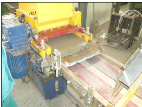
Figura 3.11 – Estrusore a spinta alternativa ed azionamento semi-automatico modello UNO 300, particolare del rullo compressore (a) e dei coltelli per l'esecuzione del taglio trasversale (b)
