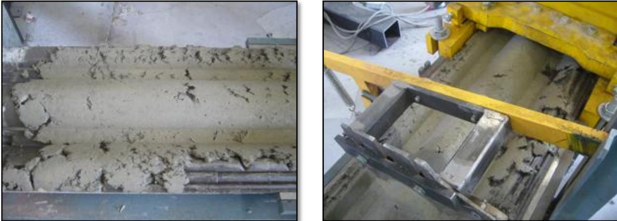
*Figura 5.7 – Test preliminari di estrusione - F09-PVA19 (rif. Tabella 3.3 a pagina 61) – Aumento eccessivo della lavorabilità a causa dell'aumento della quantità di cemento nella miscela*
