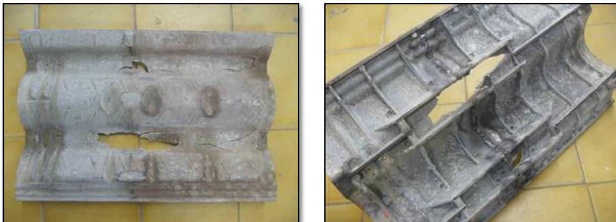
*Figura 5.5 – Test preliminari di estrusione - F09-PVA05 (rif. Tabella 3.3 a pagina 61) – Supporto di alluminio crepato a causa delle elevate pressioni di esercizio*
