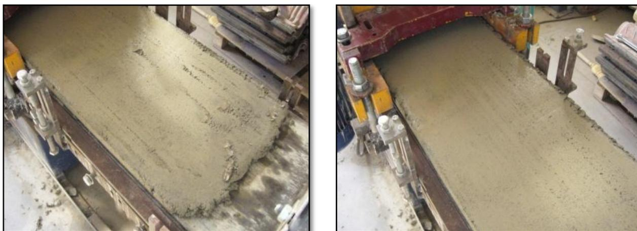
*Figura 3.15 – Fase di estrusione di piastre piane*
