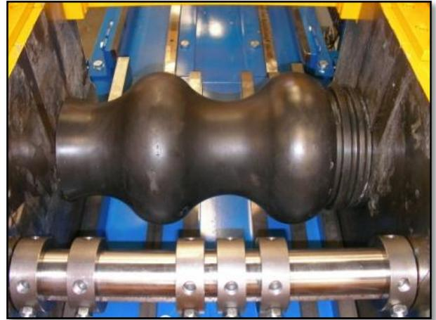
*Figura 3.1 – Estrusore con cilindro conformato per la realizzazione di tegole ondulate – particolare della testata di estrusione*
