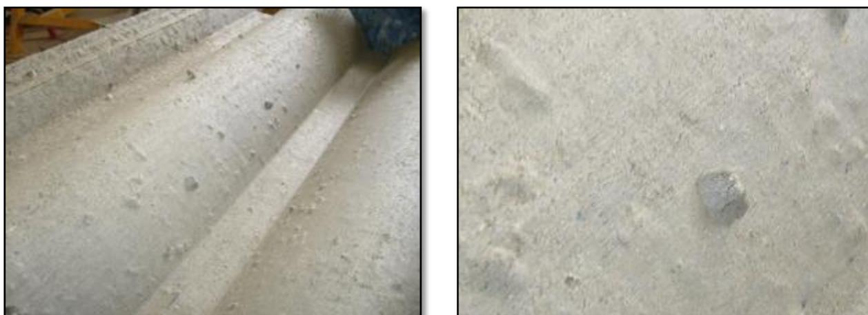
*Figura 5.6 – Test preliminari di estrusione - F09-PVA14 (rif. Tabella 3.3 a pagina 61) – Miglioramento dell'aspetto superficiale e della zona di interlocking per merito della riduzione della frazione inerte nella miscela*
