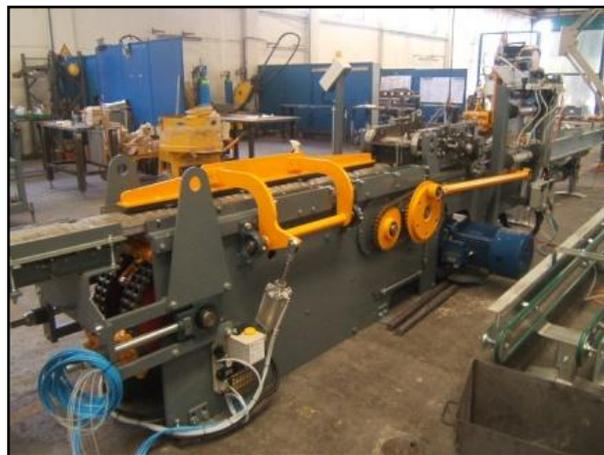
Figura 1.15 – Estrusori ad azione continua di moderna generazione
