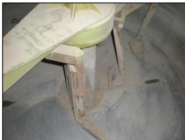
Figura 3.5 – Mescolatore planetario di 250 lt (a), planetario e pale del rotore all'interno della vasca di mescolazione (b)
