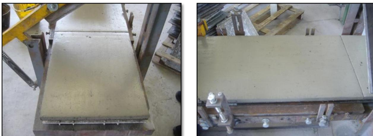
*Figura 3.16 – Fase di taglio delle piastre in uscita dall'estrusore*
