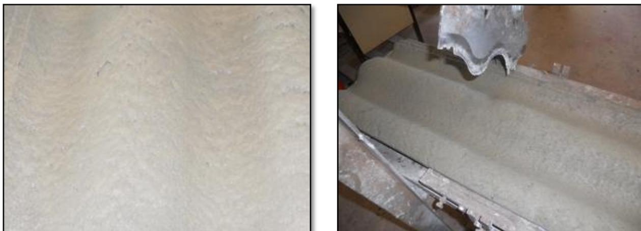
*Figura 5.19 – Test di estrusione su profilo SW5 con l'introduzione di ADD1 – Spessore ridotto*
