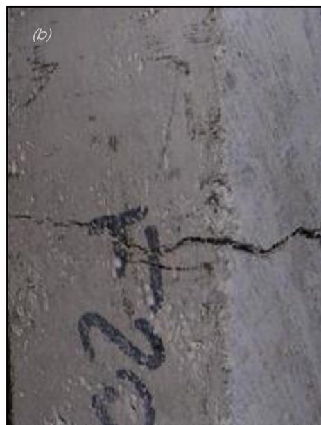
*Figura 3.27 – Prove di trazione diretta, vista generale (a) e particolare del provino fessurato al termine della prova (b)*
