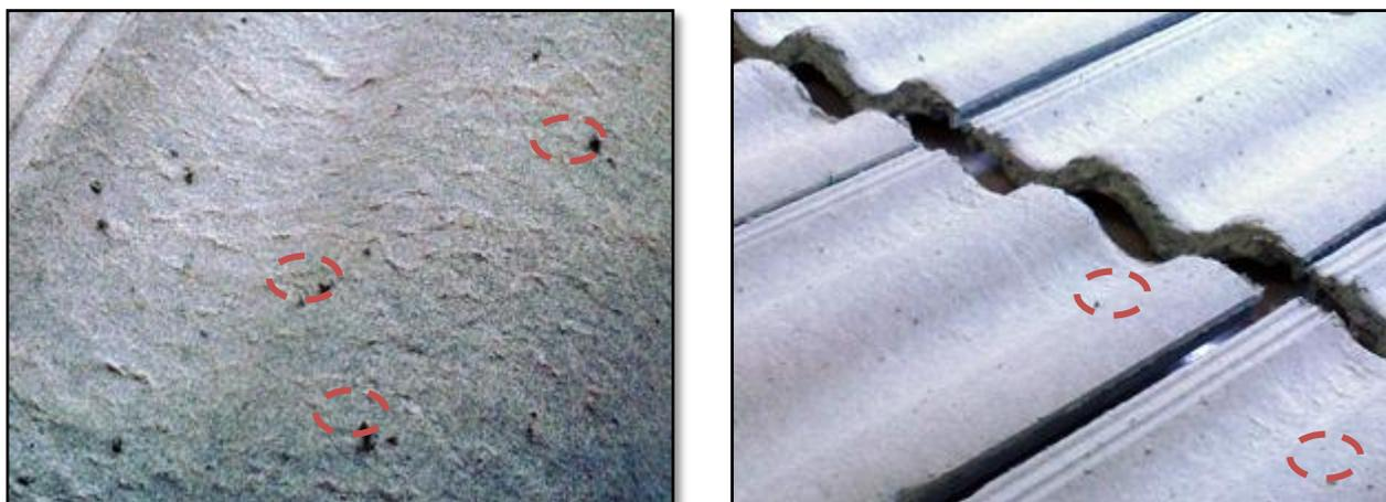
Figura 5.24 – Test di flessione a tre punti su profilo SW5 con l'introduzione combinata di ADD2 e ADD3 – Particolari che evidenziano la fuoriuscita superficiale di agglomerati di fibre
