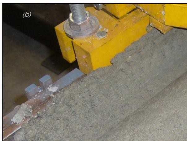
*Figura 5.3 – Test preliminari di estrusione - F09-PVA05 (rif. Tabella 3.3 a pagina 61) – (a) particolare della zona di taglio, (b) particolare della zona di interlock della tegola*
