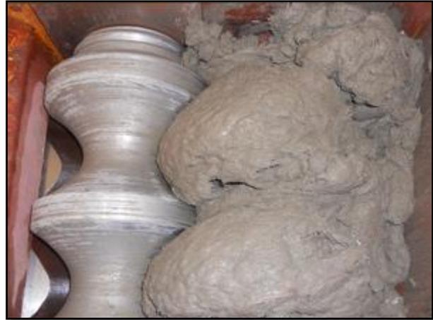
*Figura 5.9 – scorrimento non ottimale del materiale all'interno della cassa di estrusione e conseguente risultato di estrusione di una miscela viscosa*
