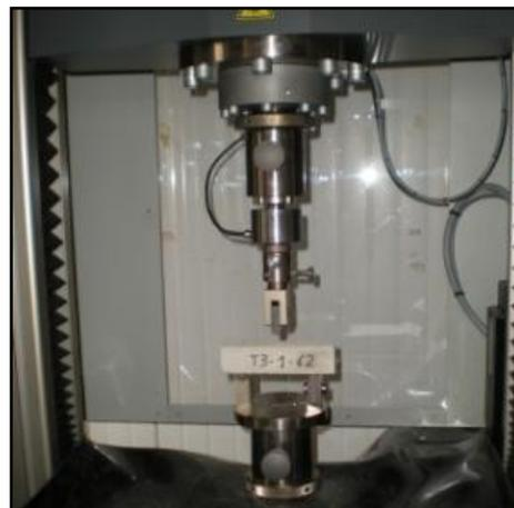
*Figura 3.22 – Prove di flessione a tre punti con lettura dell'abbassamento del punto di applicazione della forza*
