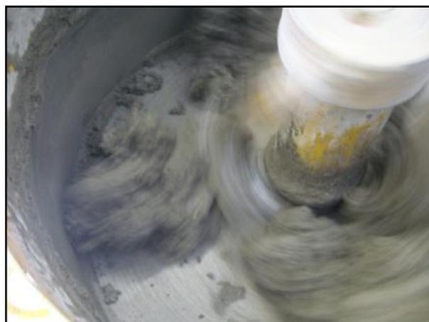
*Figura 3.10 – Mescolatore impiegato nella sperimentazione – fase di introduzione delle fibre e omogeneizzazione*
