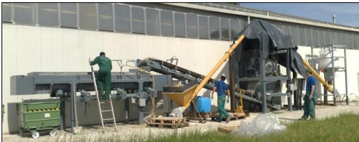
Figura 3.7 – Sistema di mescolazione a vite continuo (installato presso Vortex Hydra s.r.l.)
