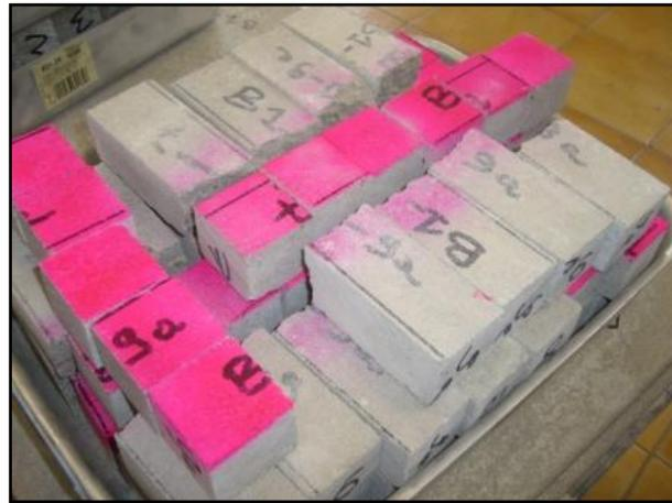
Figura 3.19 – Sega a disco diamantato impiegata per il taglio delle piastre e disposizione dei provini per le operazioni di pesatura e misurazione
