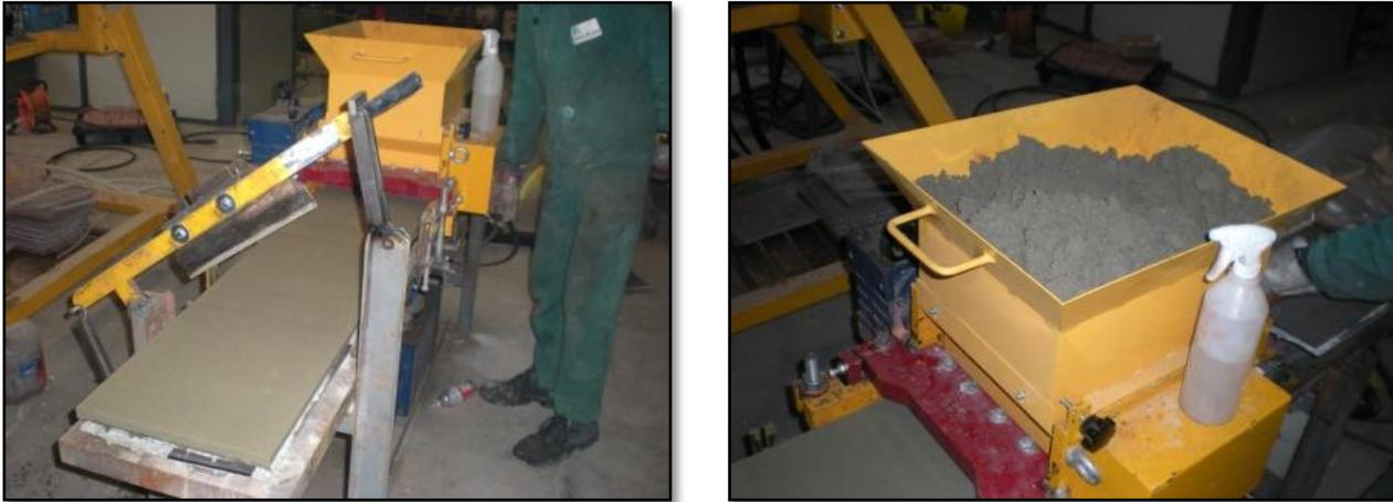
Figura 3.3 – Estrusore con cilindro conformato per la realizzazione di lastre piane – particolare dei coltelli per il taglio trasversale e della tramoggia di carico
