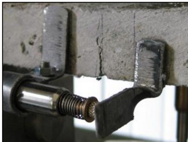
*Figura 3.24 – Prove di flessione a tre punti con lettura dell'abbassamento del punto di applicazione della forza e dell'apertura della bocca di intaglio – zona di mezzeria del provino in cui è stato applicato il trasduttore di spostamento*
