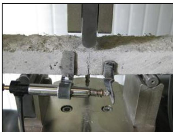
*Figura 3.23 – Prove di flessione a tre punti con lettura dell'abbassamento del punto di applicazione della forza e dell'apertura della bocca di intaglio*
