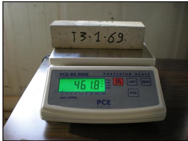
Figura 3.20 – Catalogazione dei provini e pesatura
