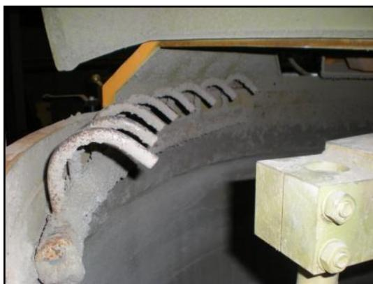
Figura 3.6 – Ugelli per l'introduzione dell'acqua all'interno della vasca di mescolazione
