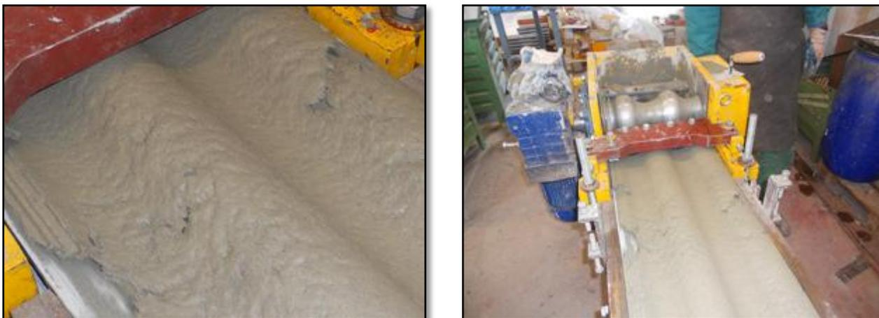
*Figura 5.17 – Test di estrusione su profilo SW5 con l'introduzione di ADD1*
