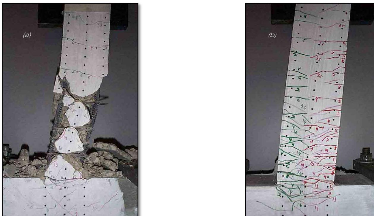
Figura 2.9 – Comportamento a rottura di un pilastro rinforzato con tradizionali armature metalliche (a) e di un pilastro rinforzato con materiali ECC senza staffe trasversali. In tutti e due i casi è stato imposto uno spostamento laterale che nel primo caso ha comportato l'espulsione del calcestruzzo superficiale e la disgregazione dello stesso anche nella zona interna alle staffe di rinforzo, mentre nel secondo caso (b) il pilastro presenta una fessurazione diffusa.
