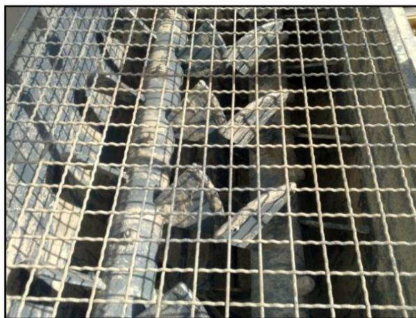
Figura 3.8 – Sistema di mescolazione a vite continuo – particolare della zona di mescolazione (installato presso Vortex Hydra s.r.l.)
