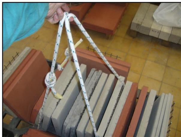
*Figura 3.17 – Preparazione delle piastre all'immersione in vasca termostata*
