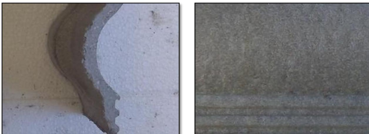
Figura 5.27 – Test di flessione a tre punti su profilo SW5 con l'introduzione combinata di ADD2 e ADD3 – Particolari che evidenziano la buona qualità delle zone aventi forma complessa – Procedura di mescolazione modificata (SQM5)
