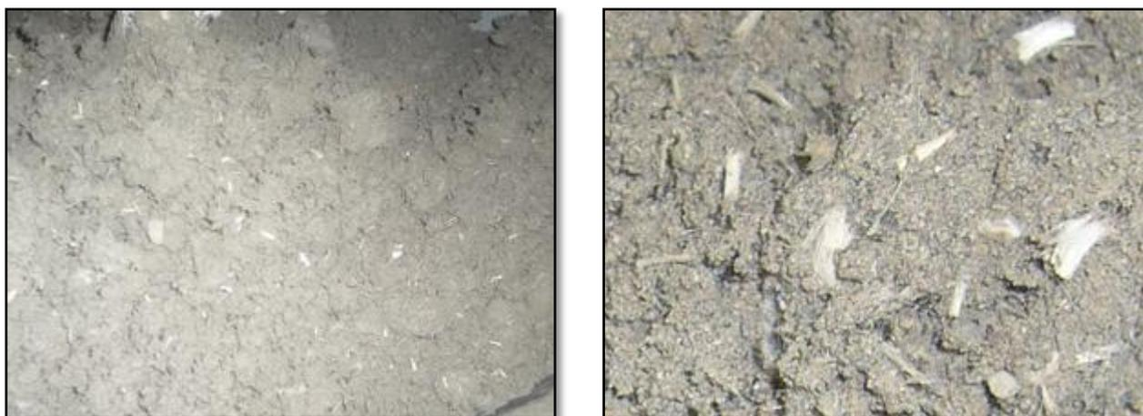
*Figura 5.4 – Test preliminari di estrusione - F09-PVA05 (rif. Tabella 3.3 a pagina 61) – Dispersione delle fibre durante le operazioni di mescolazione*
