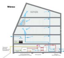
Illustrazione 51 | Riproduzione schematica della distribuzione degli impianti dedicati al riscaldamento (solare termico, cogeneratore e recuperatore di calore).
