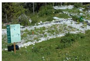
Illustrazione 31 | Uso di specie erbose montane per la realizzazione di un sistema di fitodepurazione in quota. Nella foto: sistema attualmente in fase di sperimentazione (per conto dell'Università degli Studi di Padova) al rifugio Casera Bosconero, Val Zoldana (BL), 1457 m, CAI Forno di Zoldo.
