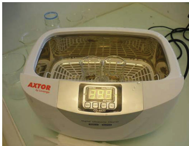
Fig. 138 - Lavaggio dei campioni nel bagno ad ultrasuoni.
