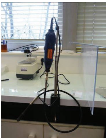
Fig. 137 - Il seghetto elettrico impiegato per il taglio dei campioni.
