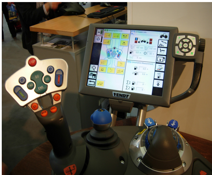
Figura 3.3: Consolle di comando FENDT con Auxiliary Input e relativa pagina di configurazione sul Virtual Terminal
