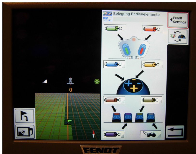
Figura 3.5: Pagina di richiamo delle associazioni realizzate tra Auxiliary Input disponibili e funzionalità comandabili da remoto in una trattrice FENDT
