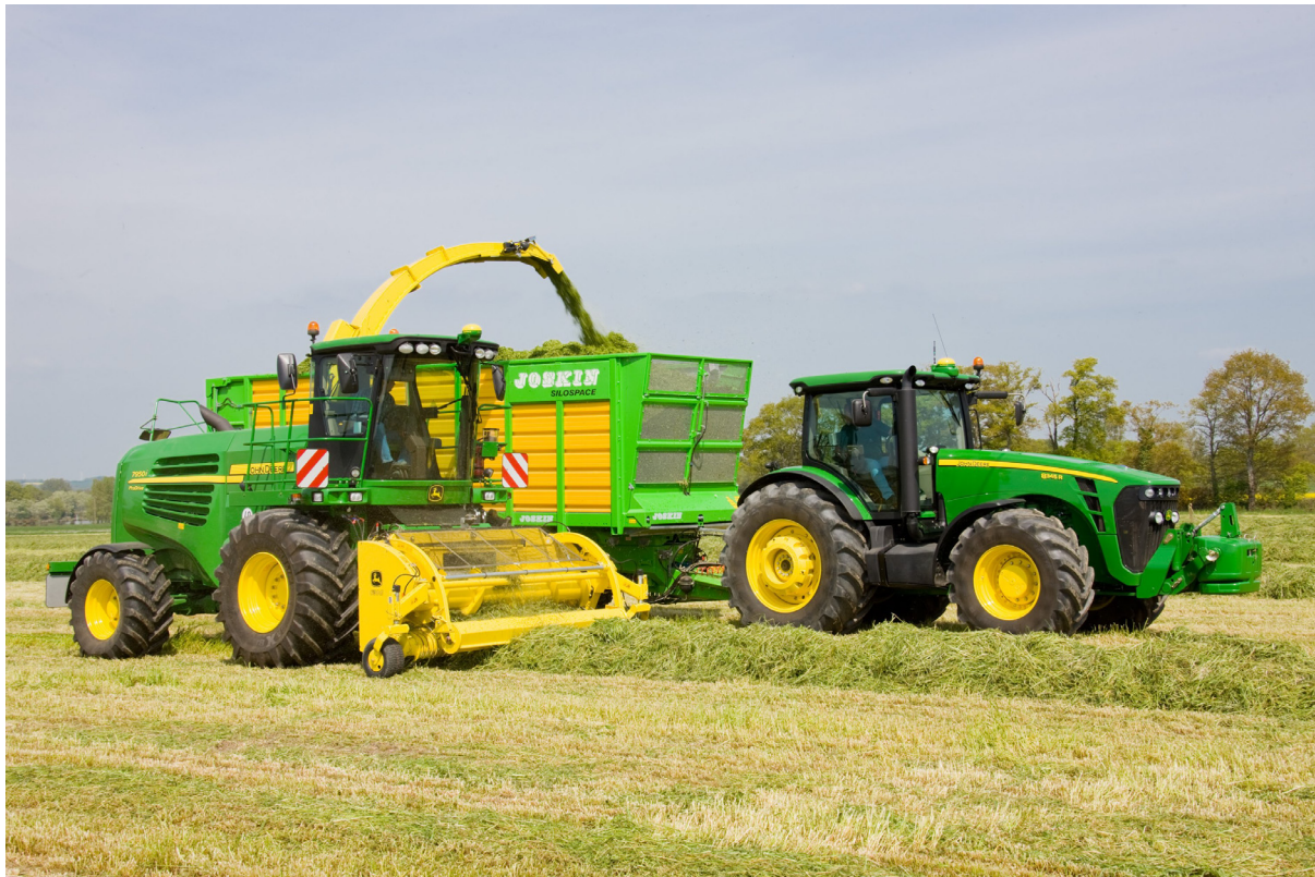
Figura 3.9: Marcia parallela di Harvester e trattoria con caricamento di materiale durante la marcia dei veicoli.
