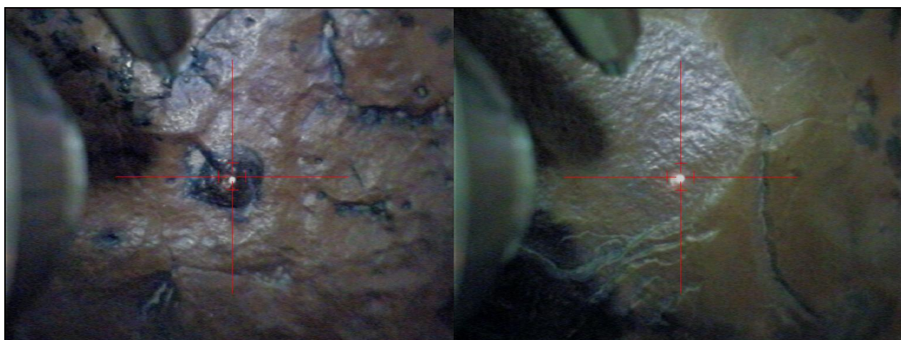
Fig. 105. Les deux points analysés sur le biface en jaspe, le premier point (à gauche) est une inclusion d'hématite, le deuxième (à droite) est la matrice siliceuse du jaspe.
