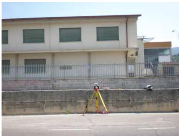
5.2 – Ricevitore GPS in modalità di ripresa statica posizionato sul punto IGM95 115706
