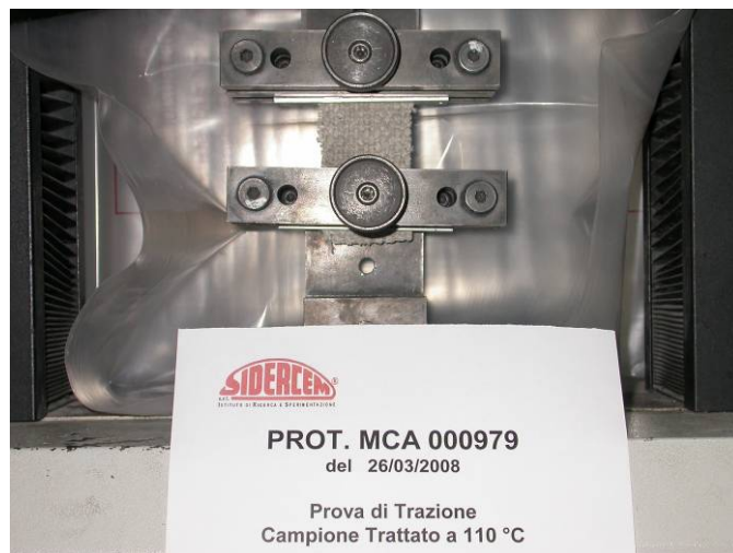
Campione di telo in amianto (110°); prova a trazione
