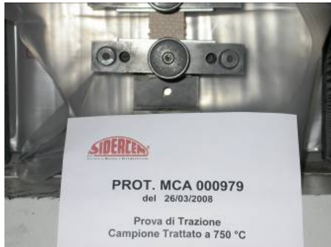
Campione di telo in amianto (750°); prova a trazione
