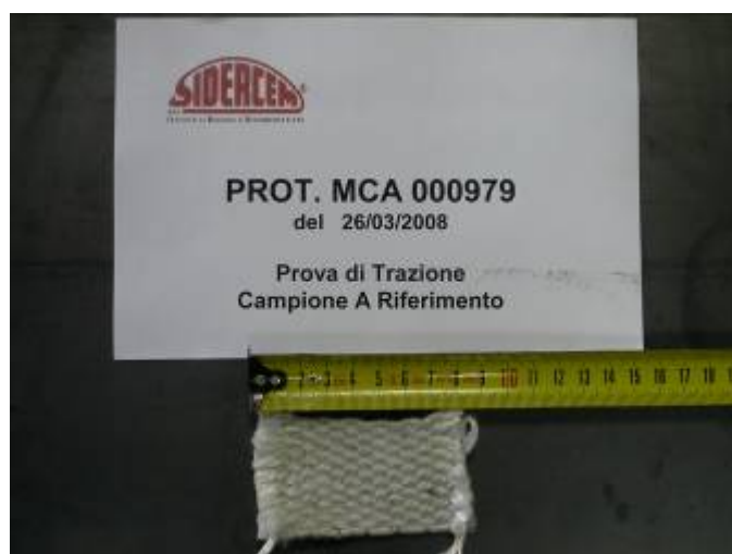
Campione di telo in amianto nuovo; prima della prova
