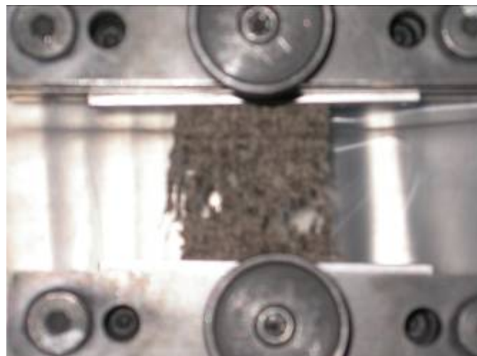
Campione di telo in amianto (250°); punto di rottura
