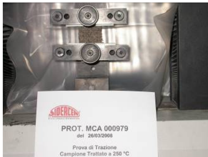
Campione di telo in amianto (250°); prova a trazione
