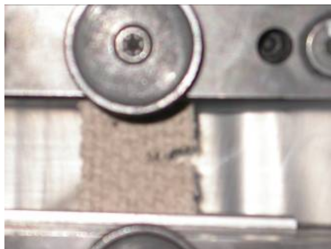
Campione di telo in amianto (750°); punto di rottura
