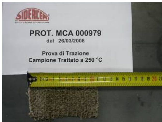
Campione di telo in amianto (250°); prima della prova
