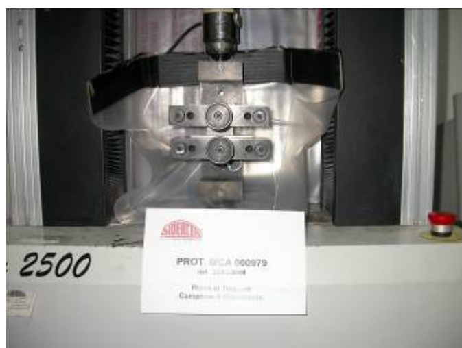
Campione di telo in amianto nuovo; prova a trazione
