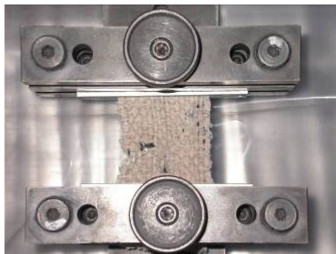
Campione di telo in amianto (550°); punto di rottura
