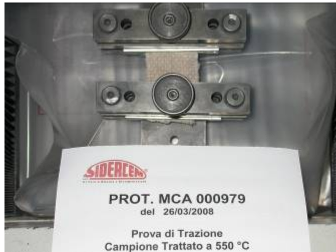
Campione di telo in amianto (550°); prova a trazione
