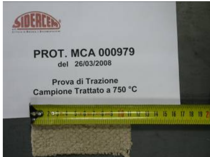
Campione di telo in amianto (750°); prima della prova
