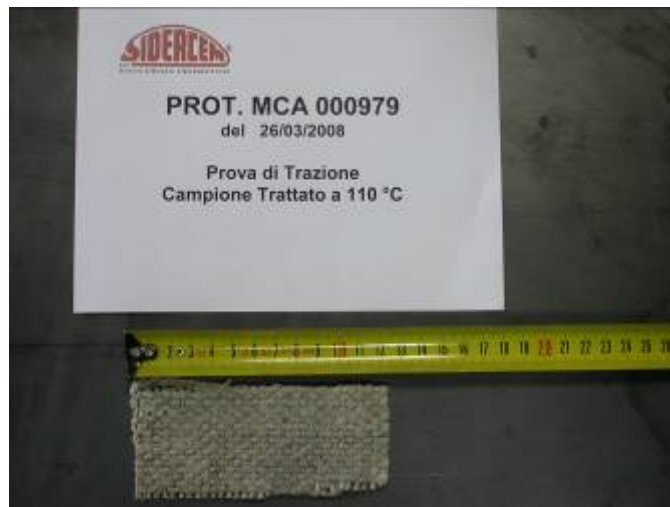
Campione di telo in amianto (110°); prima della prova
