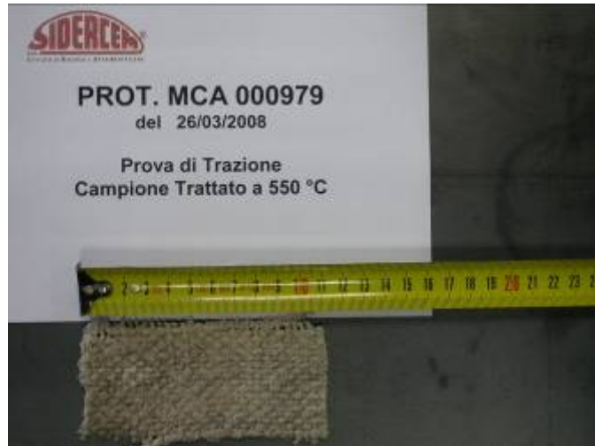
Campione di telo in amianto (550°); prima della prova
