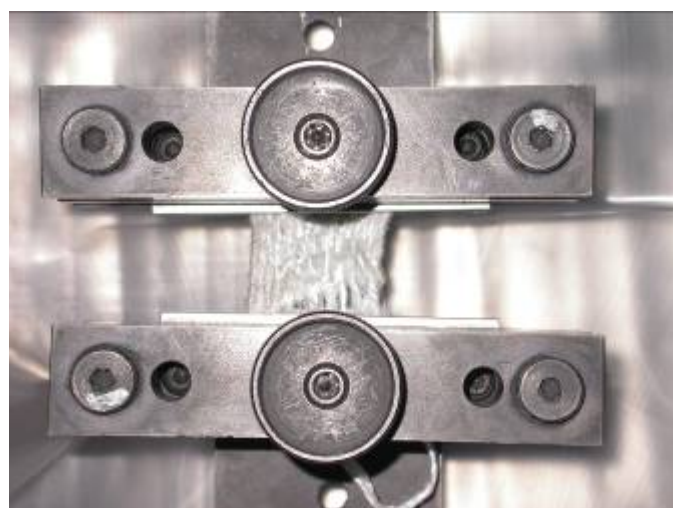
Campione di telo in amianto nuovo; punto di rottura
