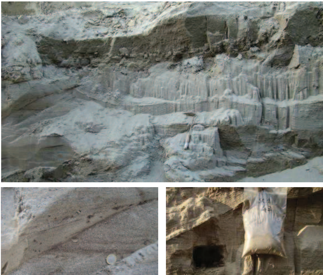
Figura 15-39 Sabbie a “stratificazione” incrociata trattiva del fiume Reno (XV° e XVI° secolo). Trincea stratigrafica aperta, in località San Carlo (FE), per studi paleosismologici in seguito agli eventi sismici del Maggio 2012.
