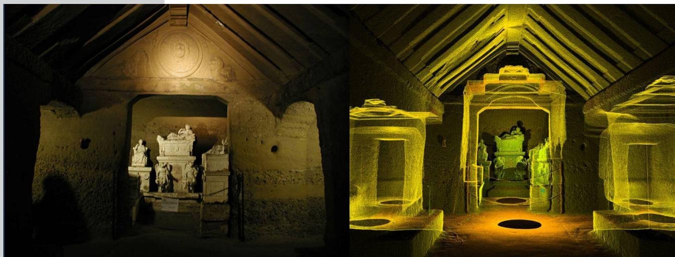
incontra e da cui è riflesso, viene determinata dalla misura del *tempo di volo* (tof, *time of flight*) che intercorre tra l'emissione e la ricezione, oppure, in alternativa per differenza di fase; la distanza, insieme alla conoscenza dei due angoli di emissione del raggio, consente di determinare per coordinate polari la posizione del punto in questione. All'utente tali coordinate vengono in prima istanza fornite in un sistema cartesiano (X,Y,Z) che ha origine nel centro strumentale.
