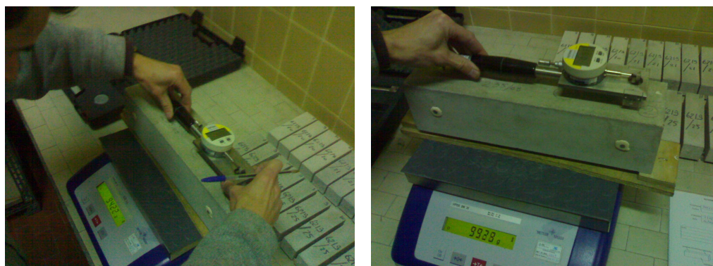
Figura 7.33- Misurazioni durante la prova di ritiro igrometrico.
