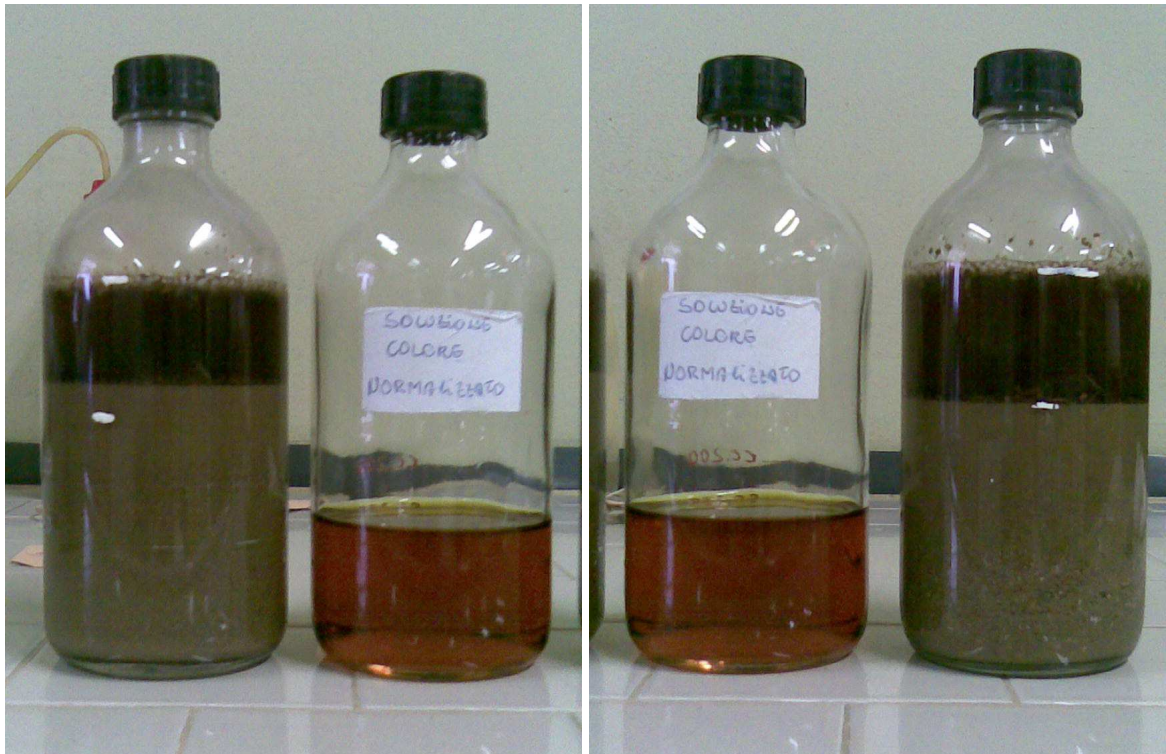
Figura 7.13- Colorazione risultata prova del contenuto in sostanza organica per la sabbia riciclata.
