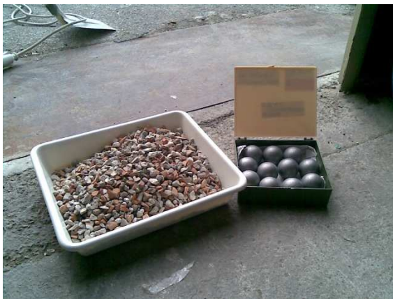
Figura 7.8- Campione prima della prova e biglie usate nella prova
