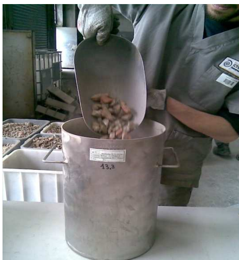
Figura 7.5- determinazione della massa volumica in mucchio.
