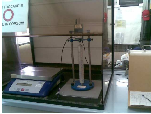
Figura 7.10- Strumentazione utilizzata per la prova di espansione accelerata, e travetti prodotti.
