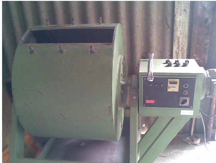
Figura 7.7- Prova di resistenza alla frammentazione Los Angeles.
