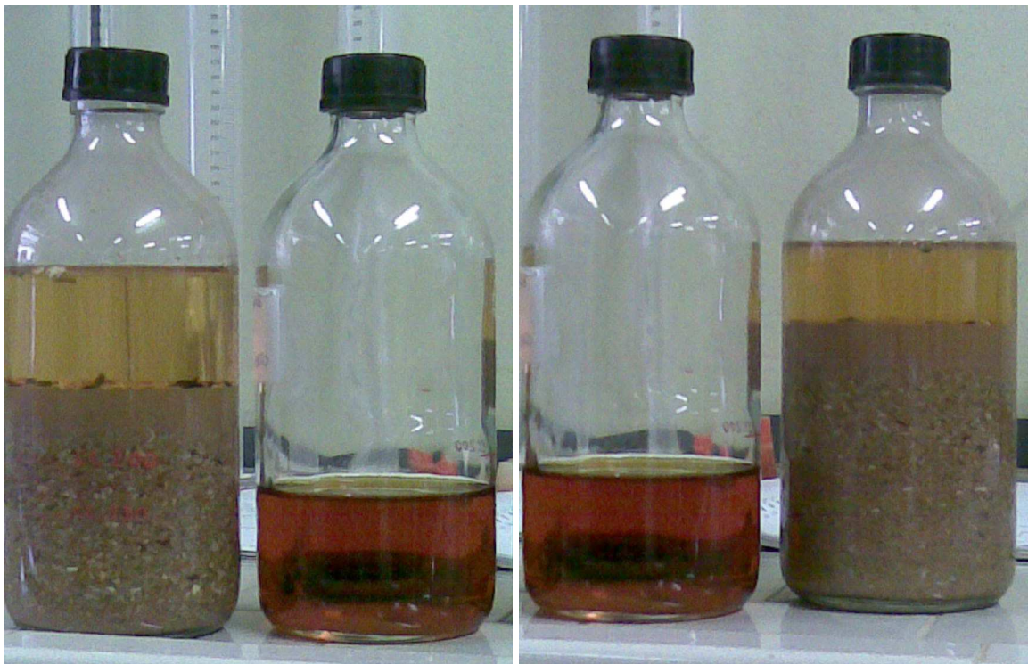
Figura 7.12- Colorazione risultata dalla prova del contenuto in sostanza organica per il materiale riciclato fraz. 0/30.
