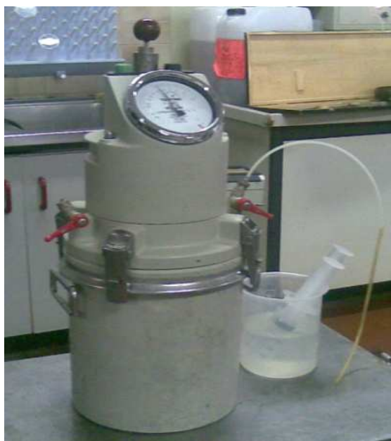
Figura 7.32- Porosimetro usato per misurare il contenuto d'aria nel calcestruzzo fresco
