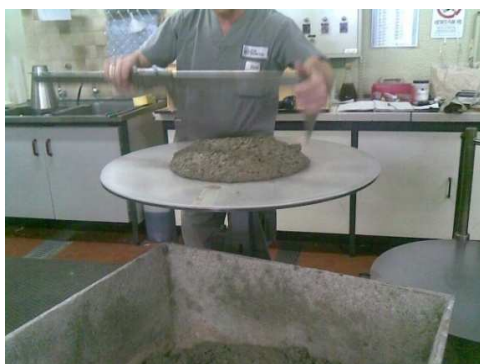
Figura 7.31- Tavola a scosse e cono di Abram usati per misurare la lavorabilità del calcestruzzo.
