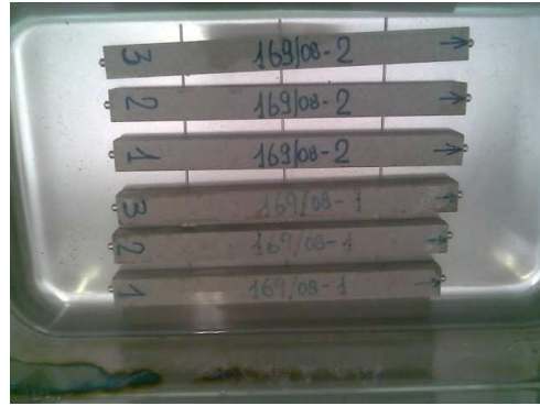
Figura 7.10- Strumentazione utilizzata per la prova di espansione accelerata, e travetti prodotti.
