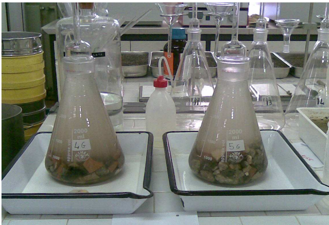
Figura 7.6- Determinazione della massa volumica media e assorbimento.
