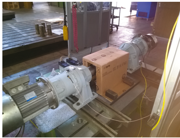
Figura 5.19: Test 3 - Configurazione per la prova di usura accelerata interrotta al primo manifestarsi del pitting rilevabile utilizzando il parametro RV.
