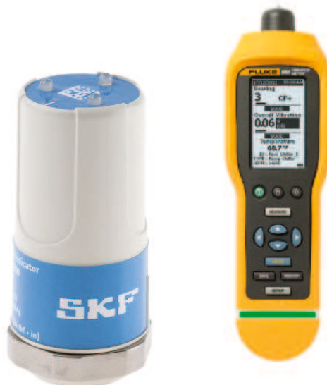
Figura 1.5: Strumenti per la misura della severità di vibrazione in accordo con la norma ISO 10816: a sinistra un accelerometro wireless SKF Indicator; sulla destra Fluke 805 Vibration Meter.
