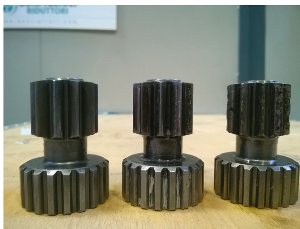
Figura 5.29: Test 4 - Confronto tra i solari del secondo stadio utilizzati: a sinistra un ingranaggio nuovo, al centro il solare estratto dal Riduttore A alla fine del Test 3, a destra il solare estratto dal Riduttore A alla fine del Test 2.
