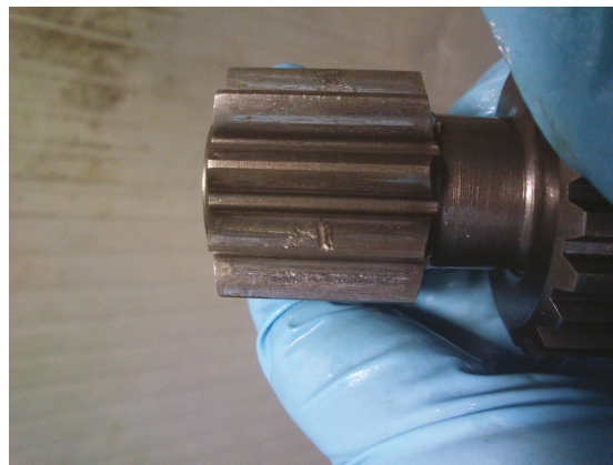
Figura 5.5: Solare del secondo stadio con un difetto localizzato artificiale sul profilo di uno dei denti.
