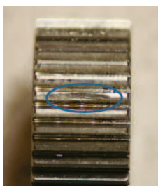
Figura 3.20: Difetto localizzato sul satellite del primo stadio.
