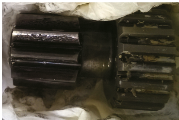
Figura 5.20: Test 3 - Dettaglio dell'usura sui denti del solare del secondo stadio del Riduttore A.
