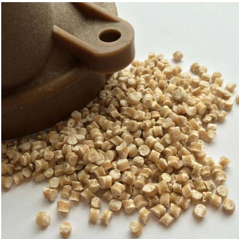
[fig. 07] Compound di PLA con fibre di canapa. Fonte: canapuglia.it
