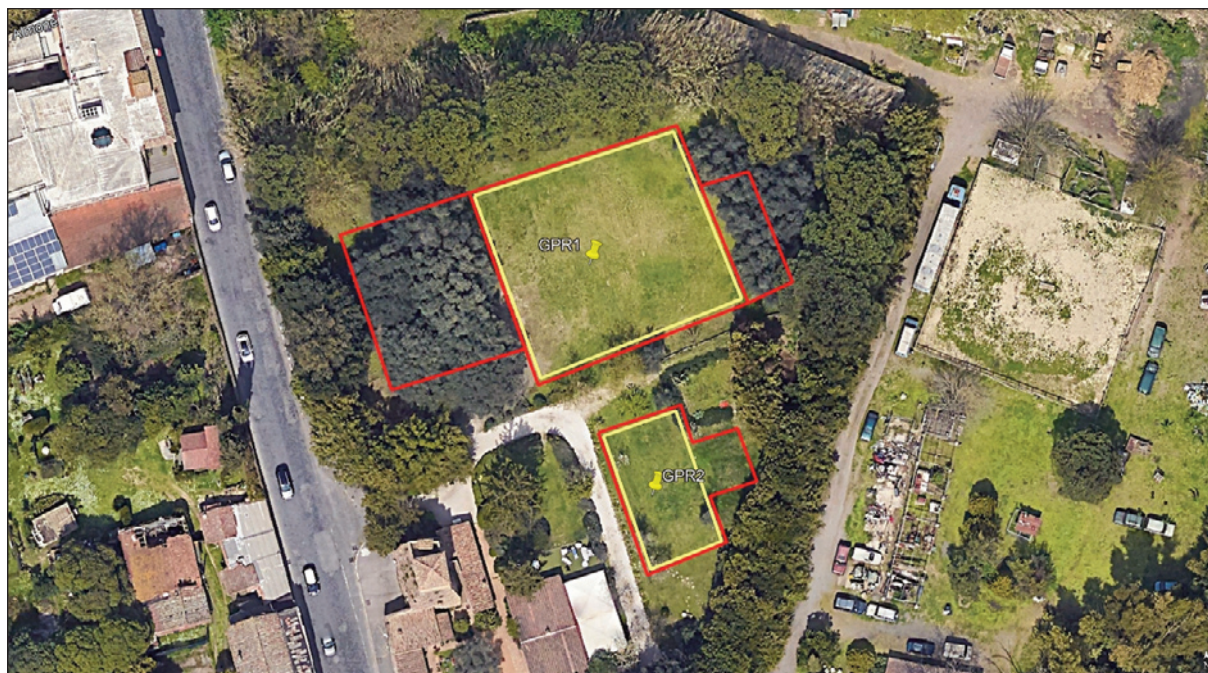
8. ROMA, VIA APPIA ANTICA, AREA DEL CD. SEPOLCRO DI GETA. PIANO DI INDAGINE ADOTTATO PER L'INVESTIGAZIONE GEOFISICA CON INDICAZIONE DELLE AREE UTILIZZATE PER L'INDAGINE GEOMAGNETICA (IN ROSSO) E QUELLE COPERTE ANCHE CON IL GEORADAR (IN GIALLO TRASPARENTE) CON PROFILI ACQUISITI NELLE DUE DIREZIONI PERPENDICOLARI ED UNA INTERLINEA DI 0,5 METRI ( elaborazione??? )
