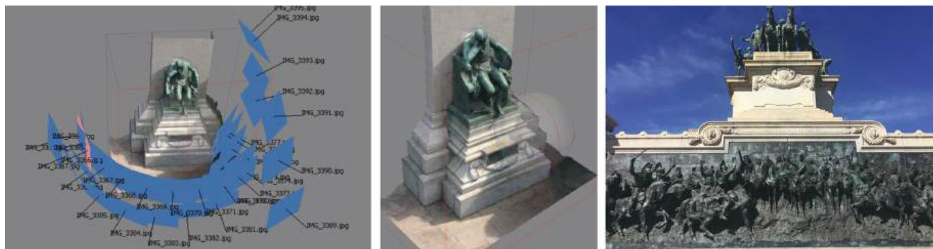
Fig. 7 - Scan to 3D photo modelling procedures: Monumento à Independência do Brasil, São Paulo, Brasil.
