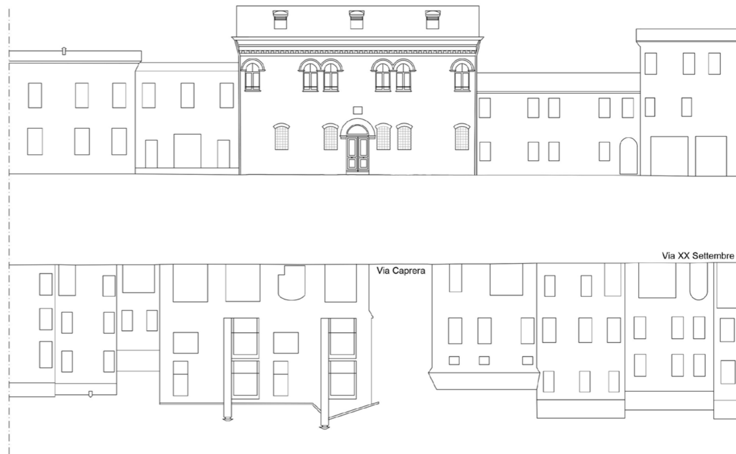
05. Elaborazioni da rilievo diretto. Schema di analisi della quinta urbana su cui sorge Casa Biagio Rossetti e del fronte opposto | Elaborations from direct survey. Schematic analysis of the urban frame on which Casa Biagio Rossetti stands and the opposite front
