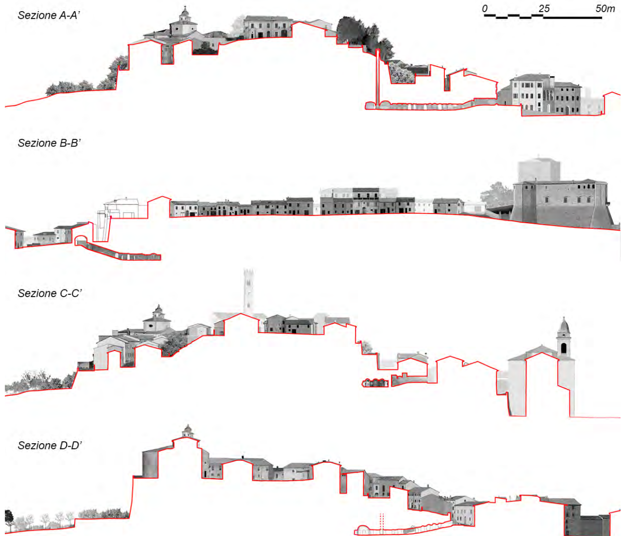
3: Sezioni ambientali ottenute tramite estrapolazione dal modello tridimensionale morfometrico a nuvola di punti, opportunamente scalate e con rappresentazione del dato di riflettanza in scala di grigio in campo bianco (elaborazione a cura degli autori).
