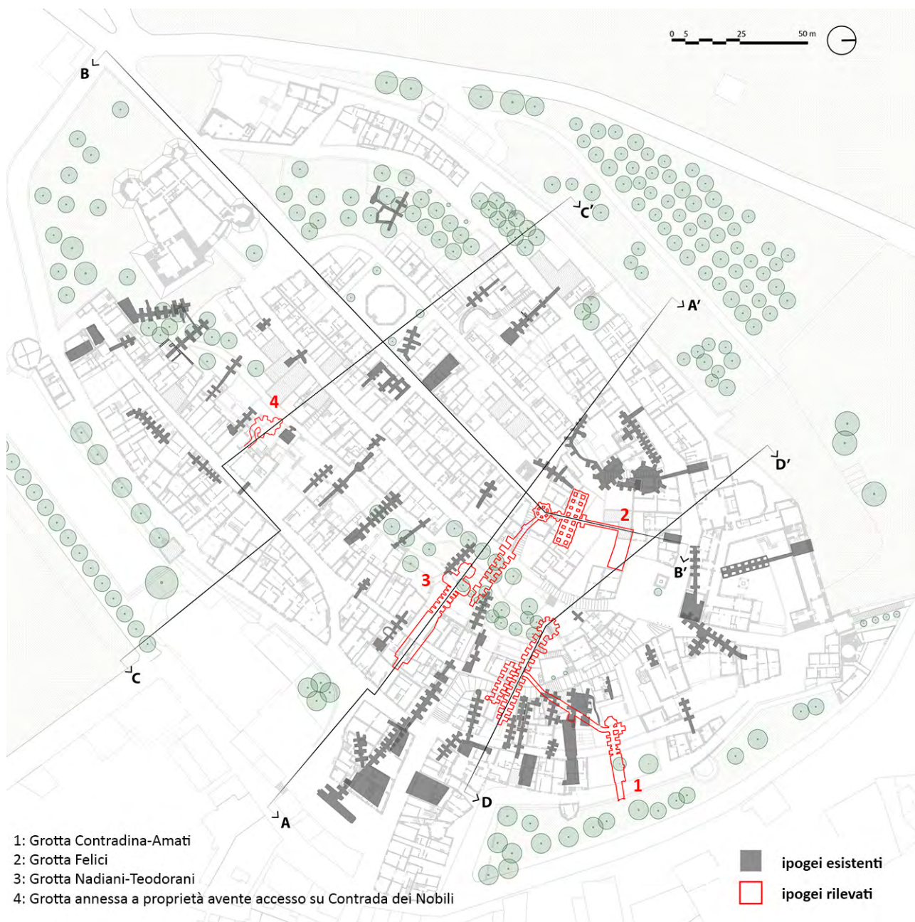
1: Planimetria dell'attacco a terra di Santarcangelo di Romagna con evidenziazione delle strutture ipogee esistenti fra cui quelle rilevate.
