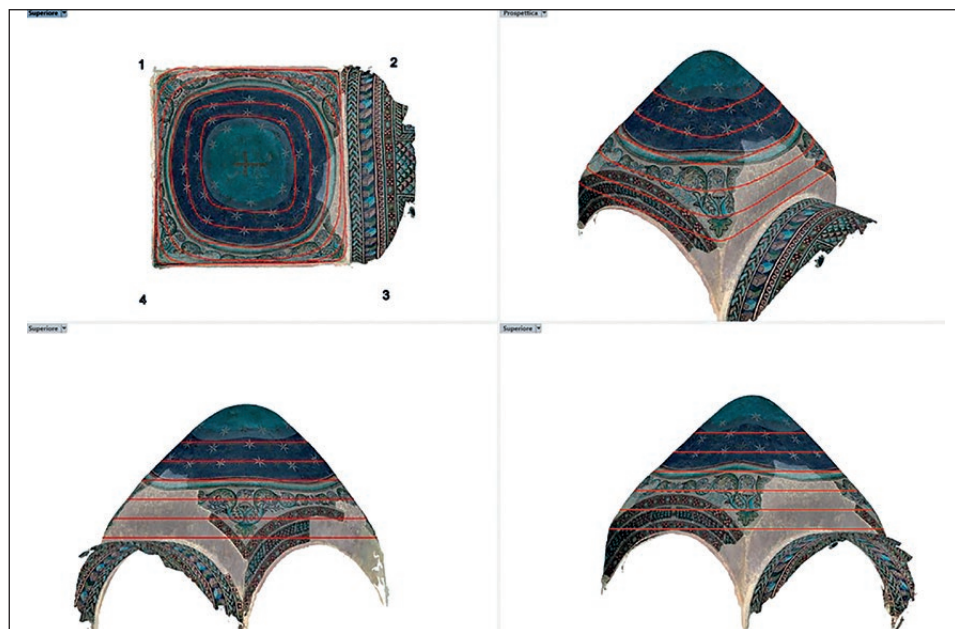
Fig. 10 – Viste ortogonali e prospettica della pseudo-cupola di Santa Maria di Casaranello. In rosso le sezioni della mesh con dei piani orizzontali. Modello elaborato mediante fotogrammetria digitale.
