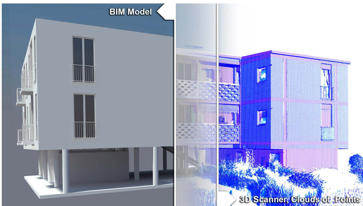
Fig. 3.8 – Esempio di traduzione del database a nuvola di punti nel linguaggio di Building Information Modeling - elaborazione centro DIAPReM
