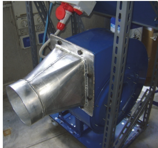
Figura 4.4 - Convergente montato sulla bocca di mandata del ventilatore.
