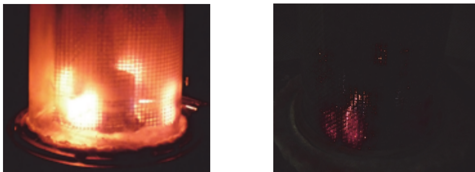
Figura 2.52 – Materiale poroso a bassa densità (sinistra) e materiale ad elevata densità (destra), alla medesima potenza di funzionamento del bruciatore modificato.
