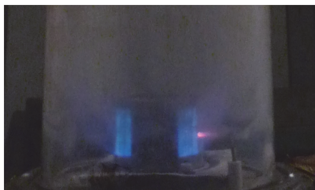
Figura 3.11 – Forma della fiamma in condizione di potenza termica P=3 kW.
