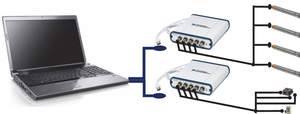
Figura 2.2 - Catena di misura utilizzata
