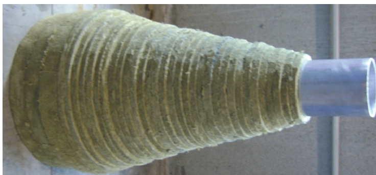
Figura 4.11 - Tubo rivestito di materiale fonoassorbente.
