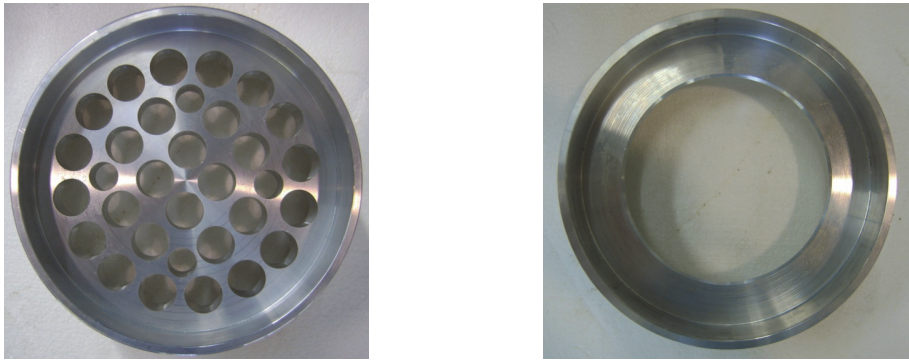
Figura 4.3 - A sinistra il raddrizzatore di flusso, a destra il diaframma
