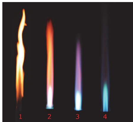
Figura 1.1 - A sinistra fiamma non areata (1), a destra fiamma premiscelata (2), al centro due fiamme parzialmente areate con diverse percentuali di aria primaria (2, 3).
